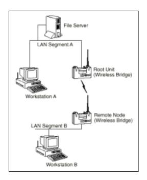
Figura 5.3 Conexión punto a punto empleando puentes inalámbricos
