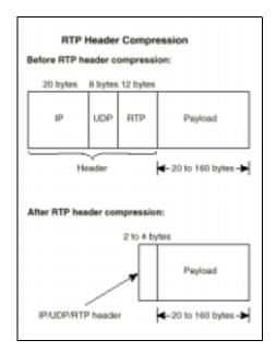
Figura 5.1 RTP Header Compression
