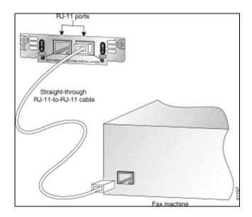
Figura 4.8 Conexión de la tarjeta FXS
