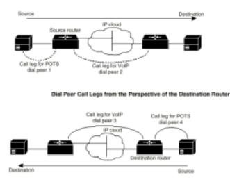
Figura 5.2 Segmentos de llamada vistos desde el router emisor (source) y el router de destino (destination).
