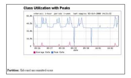
Figura 6.5 Gráfico que muestra la utilización de ancho de banda del protocolo Netbios-IP (Inbound) para el enlace CLU para un periodo de una semana (al 02 de Octubre de 2000)
