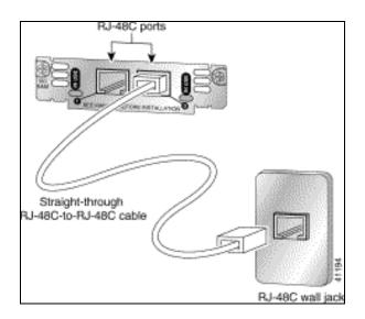
Figura 4.12 Conexión de la Tarjeta E & M
