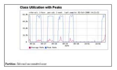
Figura 6.4 Gráfico que muestra la utilización de ancho de banda del protocolo HTTP (Inbound) para el enlace CLU para un periodo de una semana (al 02 de Octubre de 2000)
