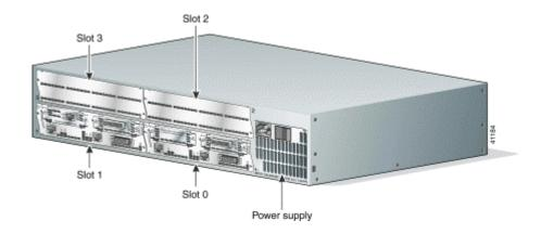
Figura 4.2 Vista posterior del Router Cisco 3640
