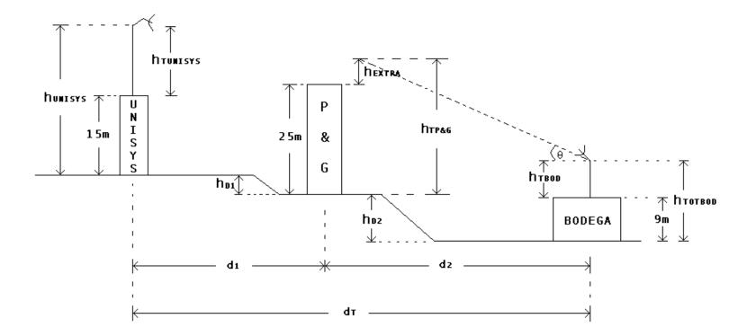
Figura 6.15 Diagrama de la ubicación de los edificios para realizar el enlace inalámbrico (diagrama realizado en Paint)
