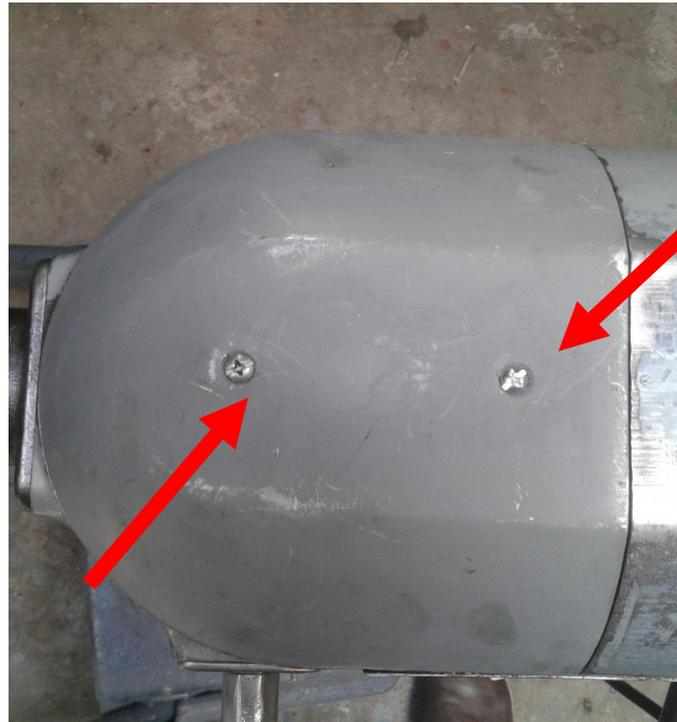
Luego de quitar la tapa, se quitan los tornillos de 5.5562 mm del eje secundario, utilizando el desatornillador tipo plano.
