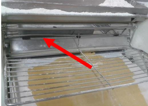
Se chequea el estado de la banda y los rodamientos, en caso de estar en mal estado por desgaste se anotan en la ficha de condiciones de equipos, para su posterior sustitución. Se chequean los mecanismos de ajuste de la banda, se limpian con desengrasante y luego se lubrican con grasa grado alimenticio para su correcto funcionamiento.
