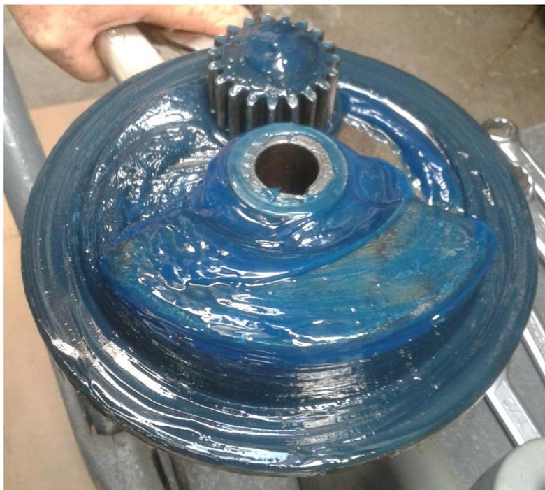
Se remueve la grasa para chequear la condición de las partes móviles, rodamientos y engranes, y si es necesario se reemplazan.
