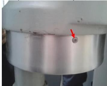
Se retiran los tornillos que sujetan el cobertor del mecanismo de elevación del tazón con la ayuda de la mano en el caso de los tornillos con cabeza de mariposa y un desatornillador Phillips para los demás tornillos.
