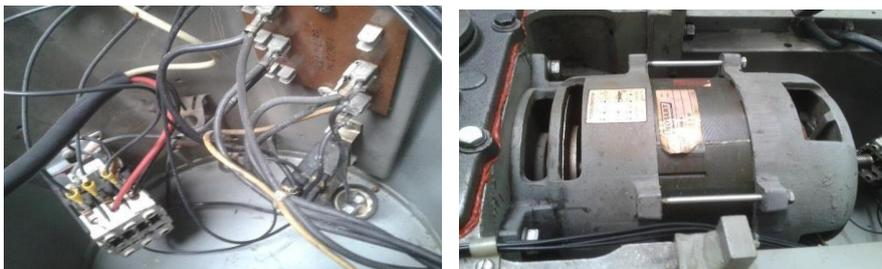
Utilizando una llave corofija o de cubo de 11 mm se procede a socar los tornillos que unen las dos piezas de la carcasa del motor (flecha roja). Luego utilizando una llave corofija o de cubo de 19 mm se procede a socar los tonillos que acoplan la carcasa del motor con la carcasa de la caja de velocidades (flecha amarilla). También utilizando una llave corofija o de cubo de 19 mm se socan los tornillos que sostienen la carcasa de la caja de velocidades al pedestal de la máquina (flecha celeste).
