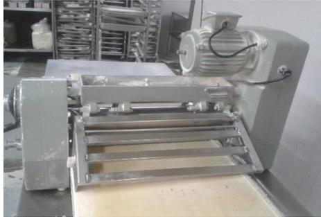
Luego se procede a colocar todas las piezas de la maquina en su lugar, al cabo del proceso de armado del equipo, se debe chequear que no falte ninguna pieza. Por terminada la inspección final de piezas. Se procede a la limpieza con desengrasante de la totalidad del equipo, con el fin de que no queden residuos de lubricantes en el equipo.
