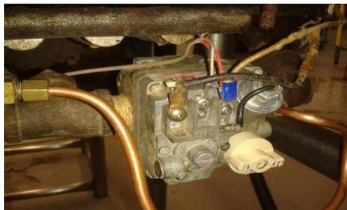
Luego se chequea todo el sistema de suministro de gas del sartén, las válvulas y los accesorios, en caso de encontrar cualquier disconformidad se procede a la reparación. En caso de que una válvula o accesorio requiera ser reemplazado por desgaste, se indica en la ficha de condiciones de equipos para su posterior sustitución.
