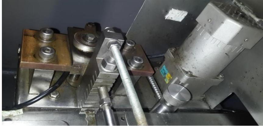
Se inspecciona la condición de la cuchilla para cortar rosquetes, se chequea que los soportes estén en buen estado, que no le falte ninguna pieza, que estén lubricados los mecanismos que producen el movimiento oscilante de la cuchilla. En caso de encontrar algún elemento en mal estado o que haga falta, se indica en la ficha de condiciones de equipos para su posterior reposición.
