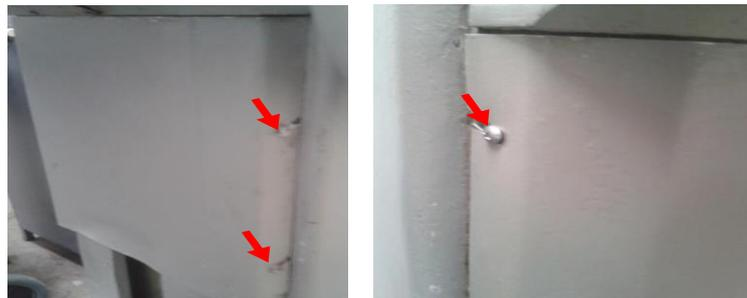
Se retira el cobertor, se procede a socar los tornillos que sujetan las guías del mecanismo de elevación con una llave Allen 7,9375 mm (flecha rojas), se socan los tornillos que fijan el tornillo principal del mecanismo (flechas amarillas). Se socan los tornillos que fijan carcasa de la caja de velocidades en la parte inferior con el pedestal con una llave Allen de 9,9250 mm (flechas celestes).
