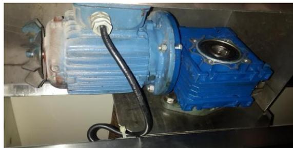
Se inspecciona la condición del motoreductor de la cuchilla cortadora de rosquetes, se chequea que los conductores no estén expuestos, que los contactores estén funcionando adecuadamente, se procede con una limpieza con desengrasante de las piezas del reductor, luego se revisa la condición de todas las piezas, en caso de alguna estar en mal estado se indica en la ficha de condiciones de equipos, para su posterior sustitución.
