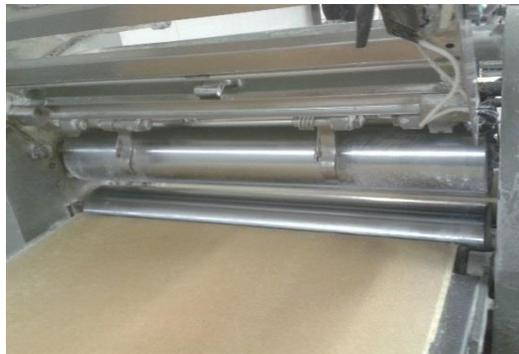
Se chequea el estado de la banda y los rodamientos, en caso de estar en mal estado por desgaste se anotan en la ficha de condiciones de equipos, para su posterior sustitución. Se chequean los mecanismos de ajuste de la banda, se limpian con desengrasante y luego se lubrican con grasa grado alimenticio para su correcto funcionamiento.
