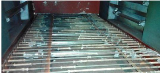
Luego se procede a colocar todas las piezas de la máquina en su lugar, al cabo del proceso de armado del equipo, se debe chequear que no falte ninguna pieza. Por terminada la inspección final de piezas. Se procede a la limpieza con desengrasante de la totalidad del equipo, con el fin de que no queden residuos de lubricantes en el equipo.
