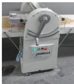
Luego se procede a colocar todas las piezas de la maquina en su lugar, al cabo del proceso de armado del equipo, se debe chequear que no falte ninguna pieza. Por terminada la inspección final de piezas. Se procede a la limpieza con desengrasante de la totalidad del equipo, con el fin de que no queden residuos de lubricantes en el equipo.
