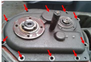
Utilizando un mazo de 500 gramos y un punzón de 5 mm quitamos las tuercas castilla del eje primario (derecha) y eje de salida (izquierda).
