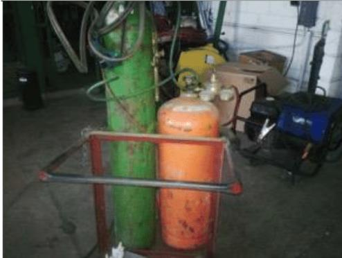
**Evidencia 3.** Cilindros de gas almacenados inadecuadamente, 29/01/2015
