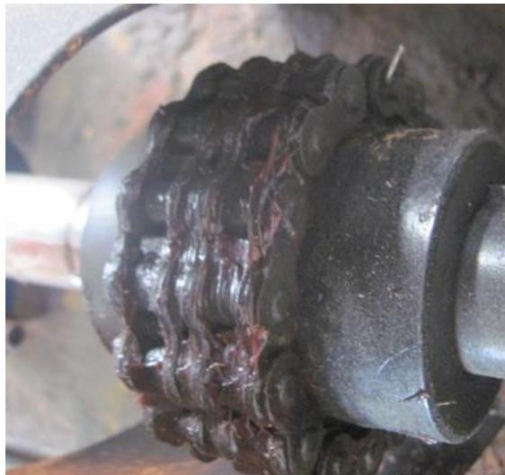
**Figura 29. Lubricación de un acople de cadena (falta protección)**
