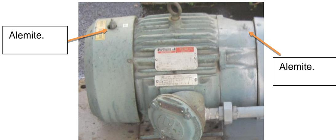
**Figura 28. Puntos de lubricación de un motor eléctrico**
