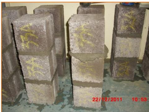
Figura 21. Construcción de los prismas formados por cubos elaborados con agregados livianos.
