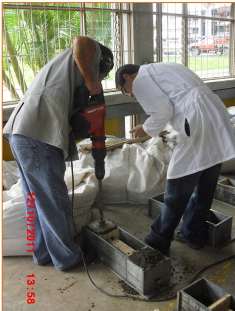
**Figura 9.** Moldeo de especímenes utilizando el martillo vibratorio
