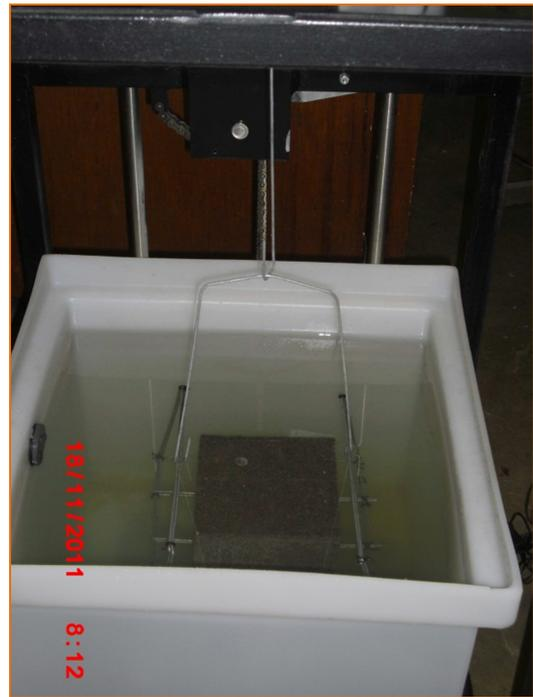
Figura 15. Determinación del peso sumergido de los especímenes
