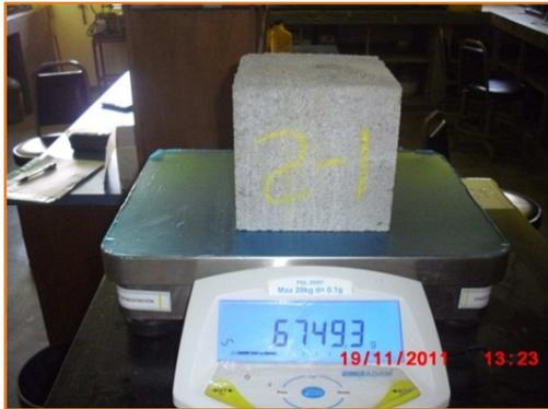
Figura 16. Determinación del peso seco de los especímenes
