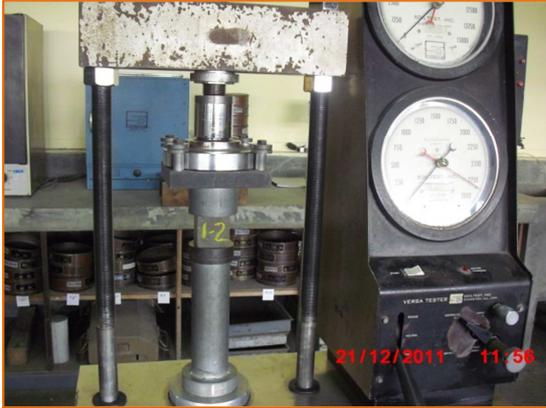
Figura 24. Ensayo de resistencia a la compresión de cubos de mortero
