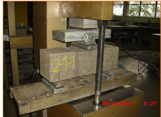
Figura 22. Montaje de la prueba de adherencia
