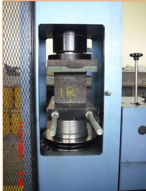
Figura 18. Ensayo de resistencia a la compresión
