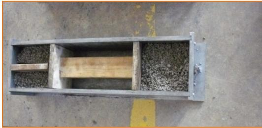
**Figura 8.** Método para el moldeo de cubos de 15cm de lado utilizando vigas y separadores de madera
