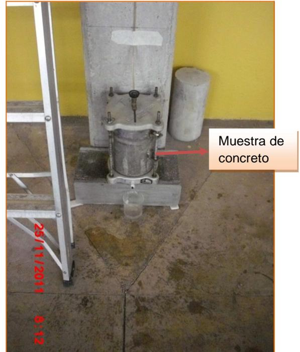
Figura 25. Permeámetro de carga variable
