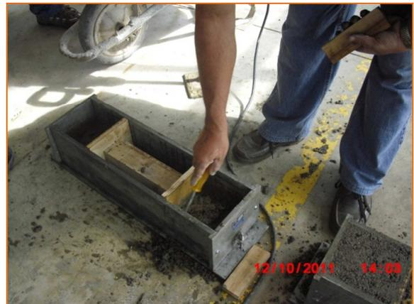
**Figura 12.** Escarificación (rallado) de la superficie
