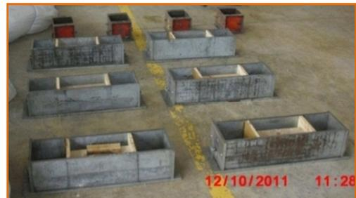
Figura 6. Preparación de moldes para la elaboración de los especímenes
