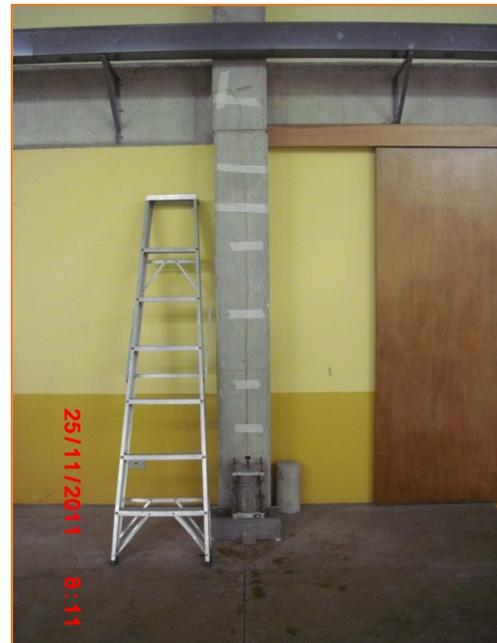
Figura 26. Montaje de la prueba de permeabilidad
