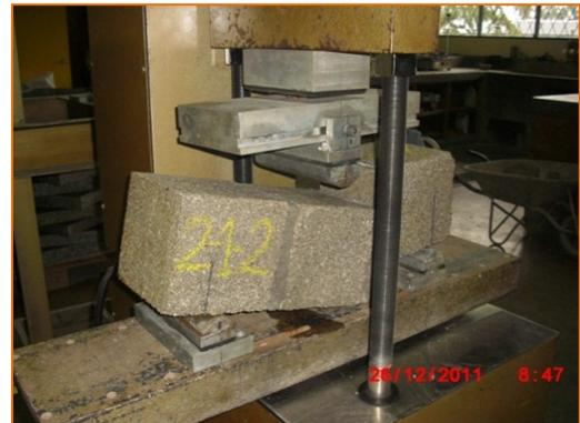
Figura 23. Falla de prismas durante el ensayo de adherencia
