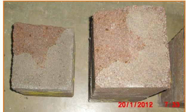
Figura 62. Adherencia entre el mortero de pega y los bloques elaborados con agregados livianos
