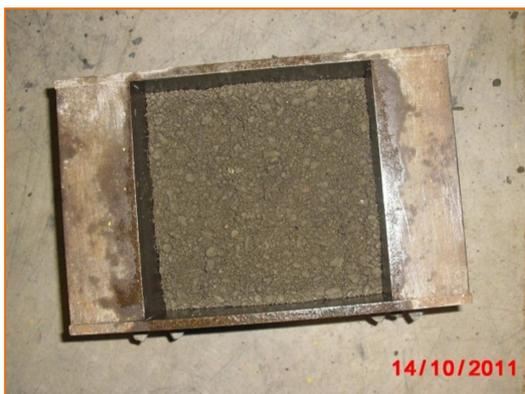
**Figura 10.** Superficie resultante después de los 10 segundos de vibro compactación del martillo vibratorio
