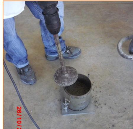
**Figura 11.** Moldeo de espécimen para prueba de permeabilidad
