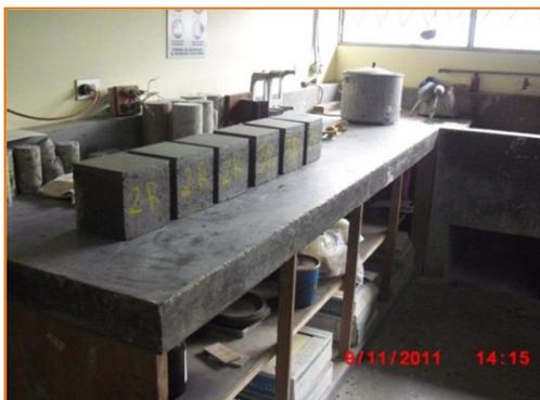
Figura 17. Coronamiento de los especímenes
