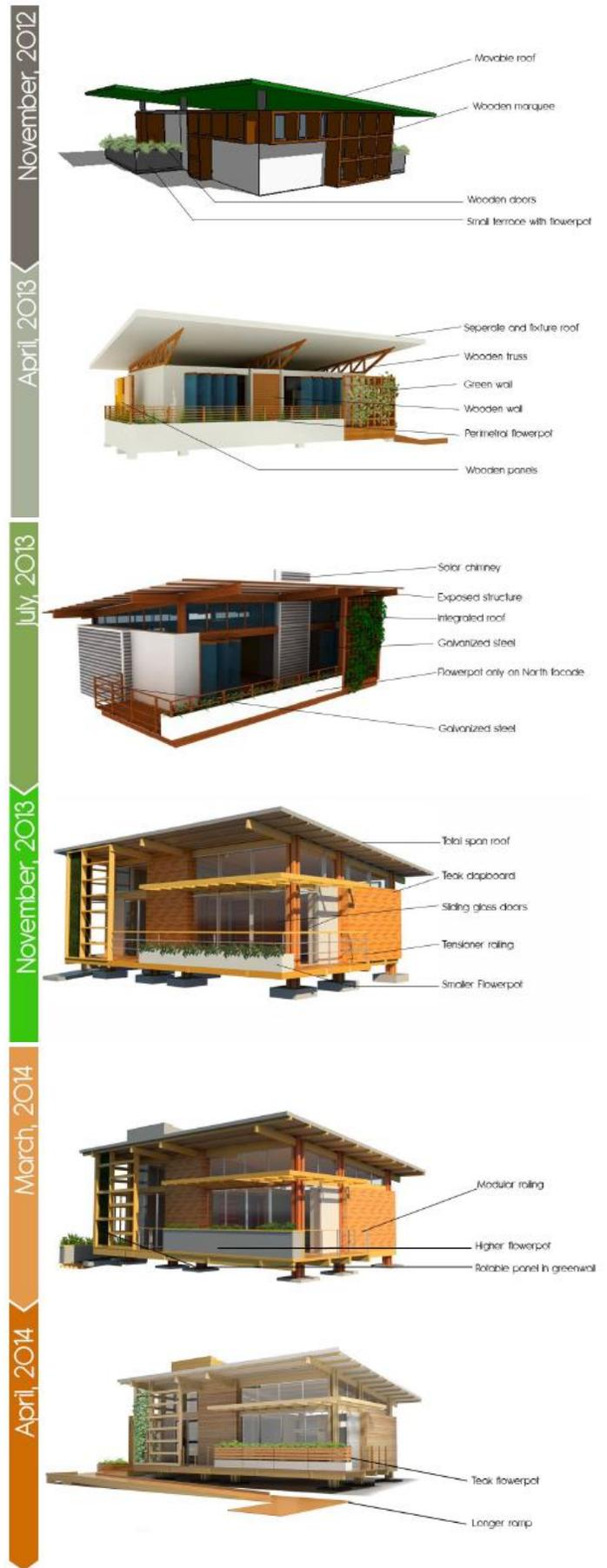
**Figura 8:** Evolución del diseño del módulo Tropika realizado por el TEC Team
