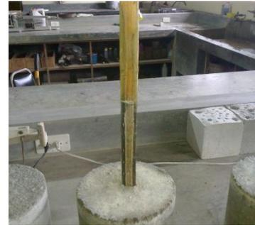
Figura 39. Bambú extraído del cilindro de concreto.
