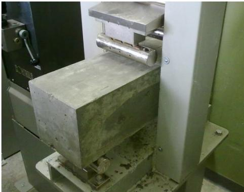
Figura 28. Ensayo de flexión en vigas reforzadas.
