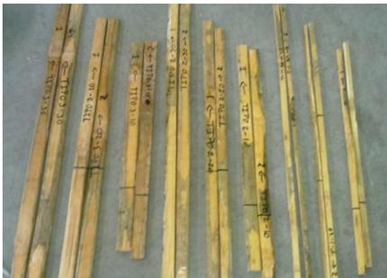
Figura 17. Probetas de bambú utilizadas en la prueba de adherencia entre el bambú y el concreto.
