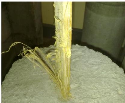
Figura 54. Probeta de adherencia fallada con bambú liso.
