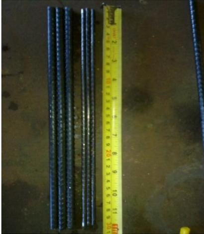
Figura 10. Probetas de acero sometidas a ensayos de tensión.
