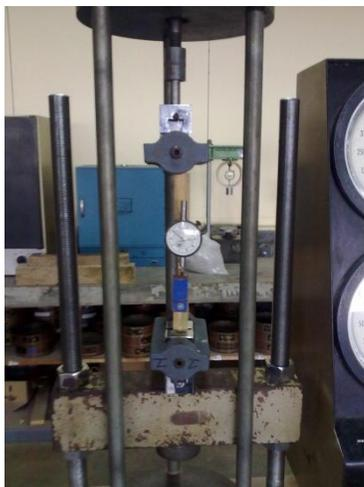
Figura 14. Máquina Versa utilizada para ensayos a tensión en bambú.
