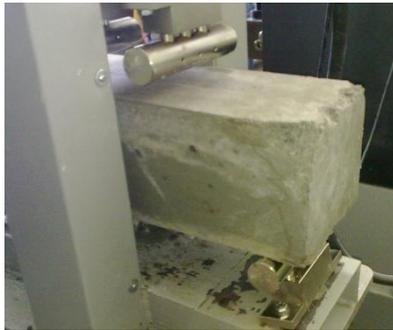
La falla en estos elementos demostró que el refuerzo con bambú ocasiona que la falla sea frágil, esto porque se están combinando materiales cuya falla es de este tipo. Además las capacidades de los elementos reforzados con acero superan ampliamente a los reforzados con bambú.
