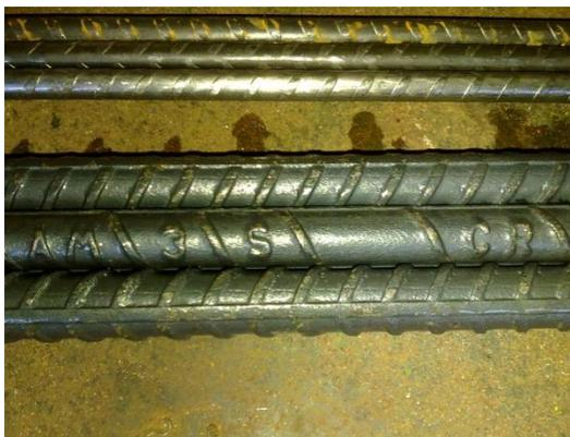
Figura 29. Varilla #3 muestreada para ensayo a tensión en acero.
