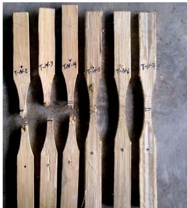
Figura 44. Probetas falladas de bambú con nudo y de sección reducida.
