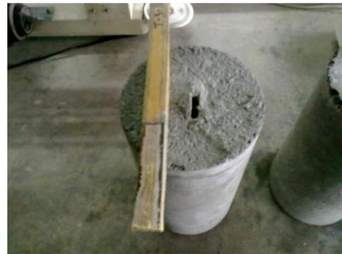
Figura 23. Probeta de adherencia fallada.
