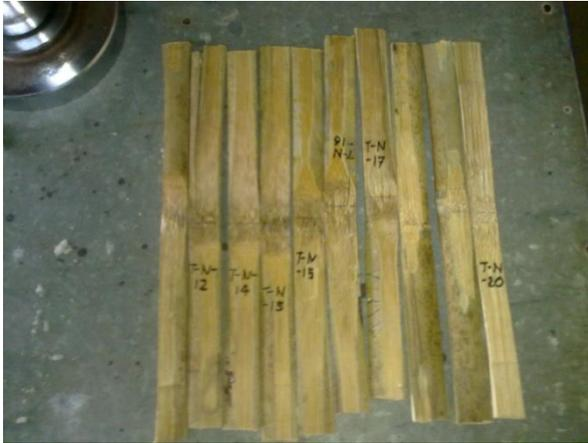
Figura 32. Probetas de bambú con nudo ensayadas en la máquina Versa.
