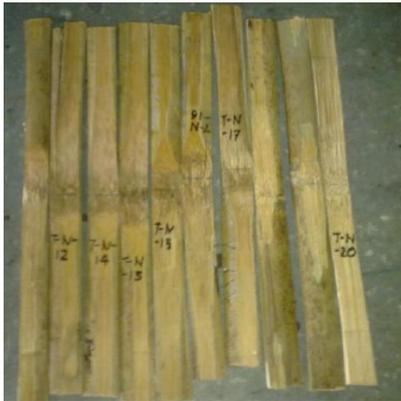
Figura 13. Probetas de bambú preparadas para el ensayo a tensión.
