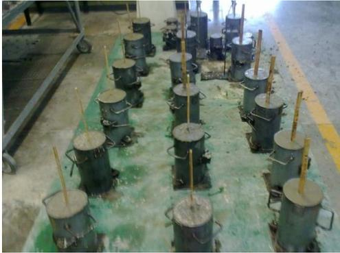
Figura 20. Probetas para la prueba de adherencia entre el bambú y el concreto recién elaboradas.
