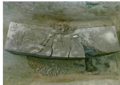
Figura 42. Elemento fallado a flexión.
