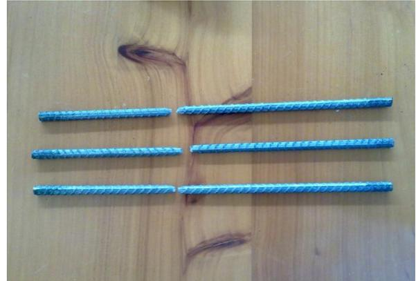
Figura 12. Probetas de bambú probadas mediante el ensayo a tensión.
