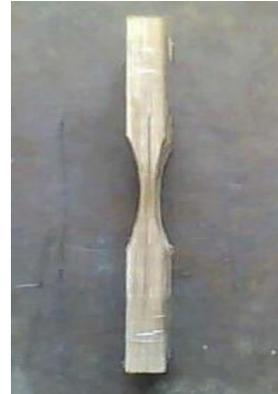
Figura 15. Probetas de bambú con reducción en la sección.
