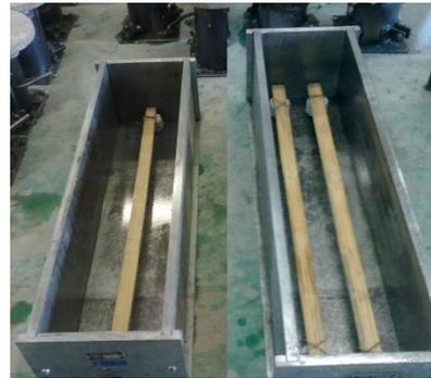
Figura 25. Vigas de concreto reforzadas con bambú.
