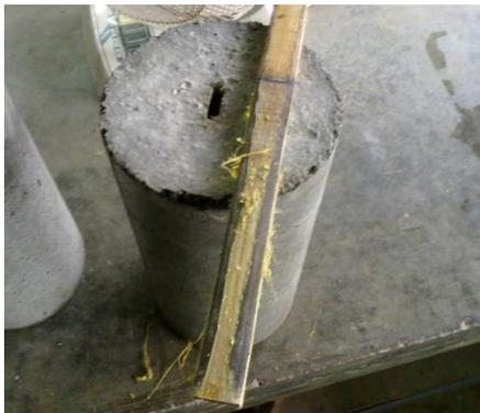
Figura 48. Probetas T3 falladas a extracción.
