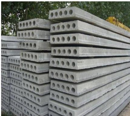
Figura 3. Elementos (losas) de concreto prefabricado.
