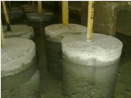
Figura 21. Método de curado para las probetas de adherencia entre el bambú y el concreto.
