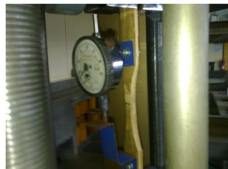
Figura 16. Probeta de bambú con deformímetro en la parte central.
