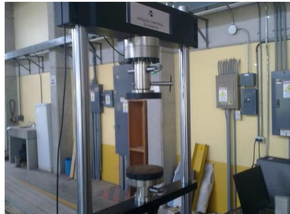
Figura 9. Máquina Universal de Ensayos utilizada para las pruebas a tensión.
