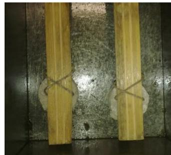
Figura 26. Vigas de concreto reforzadas con bambú.
