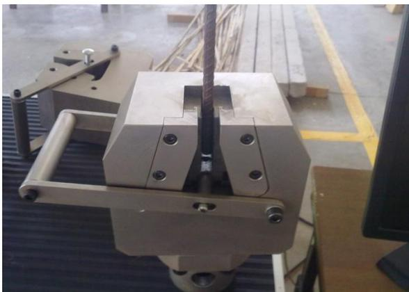
Figura 11. Probeta de acero anclada a mordaza para ensayo a tensión.
