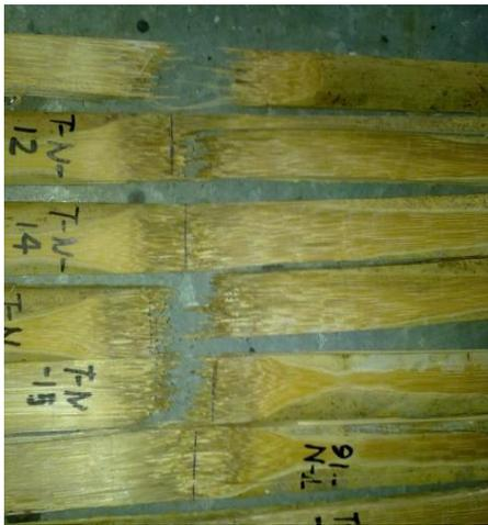
Figura 34. Probetas de bambú con nudo ensayadas a tensión.
