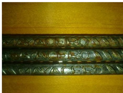
Figura 30. Varilla #2 muestreada con el sello del fabricante.
