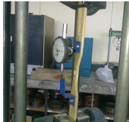
Figura 37. Ensayo en bambú para corroborar la medición del módulo elástico.
