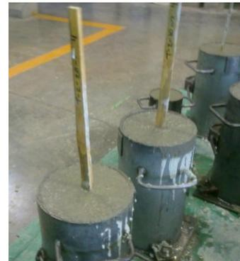
Figura 46. Especímenes utilizados para pruebas de adherencia.
