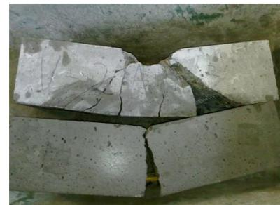
Figura 58. Comparativa entre elementos fallados a flexión.
