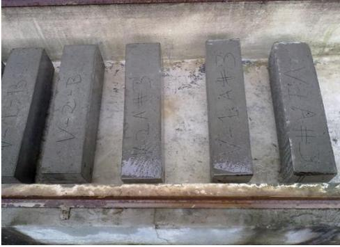
Figura 27. Curado de las vigas de concreto.
