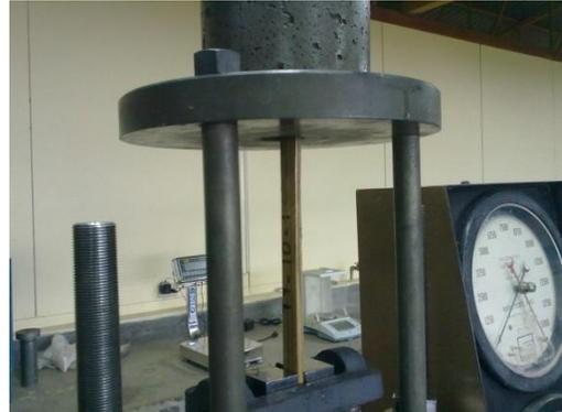
Figura 22. Ensayo de adherencia entre el bambú y el concreto.
