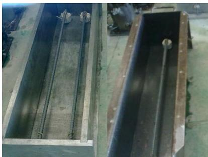
Figura 24. Vigas de concreto reforzadas con acero (varilla #3).
