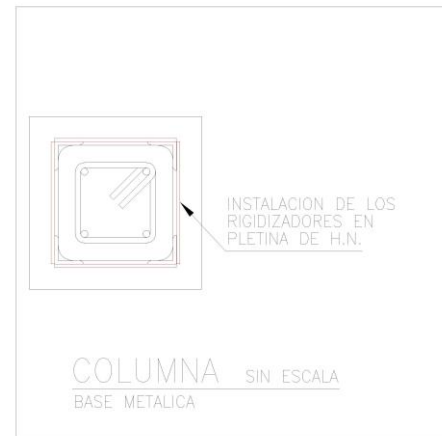
Figura 10. Ubicación de rigidizadores. Autocad 2005.
