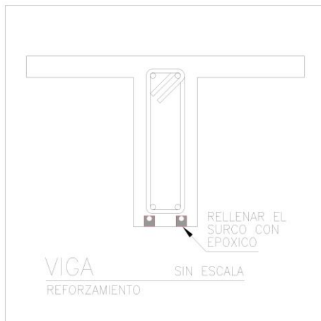
Figura 5. Relleno de surcos. Autocad 2005.
