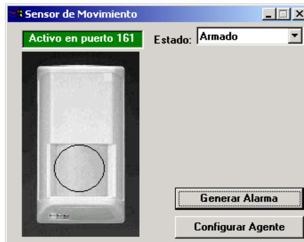
Figura 27. Interfaz del emulador de un sensor de movimiento
