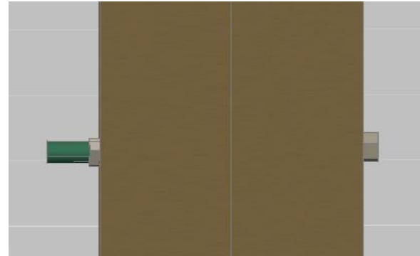
Figura 9. Detalle de unión entre paneles a cada 61cm
