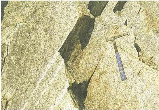
**Figura 31.** Meteorización de macizo rocoso grado II gneis glandular con matriz rocosa y superficies de discontinuidad ligeramente decolorada. (Ferrer,2004)
