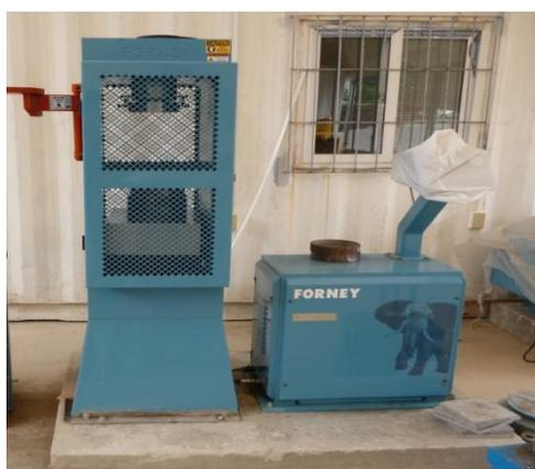
**Figura 102.** Maquina de compresión marca Forney Automatic F-502.
