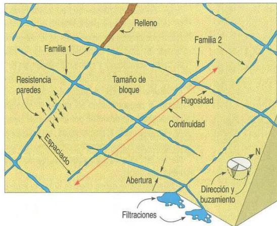
**Figura 11.** Representación esquemática de las propiedades geomecánicas de las discontinuidades. (Ferrer,2004)
