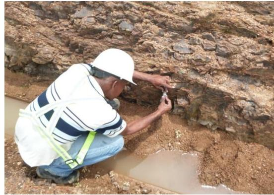
**Figura 37.** Medición del buzamiento en junta media J1 del talud 2, primera parte.
