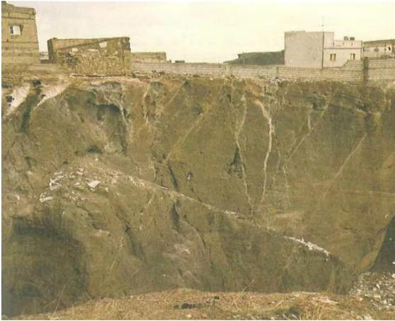
**Figura 28.** Macizo rocoso volcánico masivo con bloques muy grandes. (Ferrer,2004)
