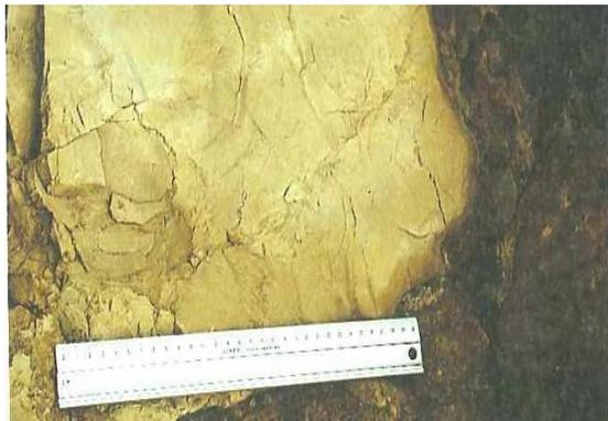
**Figura 32.** Meteorización de macizo rocoso grado III macizo calizo y cuarcítico moderadamente meteorizado con alteración en las superficies de discontinuidad. (Ferrer,2004)
