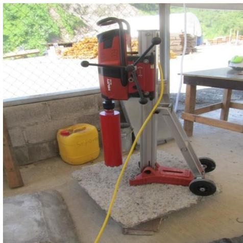
**Figura 101.** Extractor de núcleos marca HILTI DD 200, sobre una artesa de concreto lanzado con fibra.
