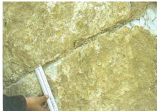
**Figura 23.** Discontinuidad plana rugosa, con abertura ancha y relleno arcilloso seco. (Ferrer,2004)
