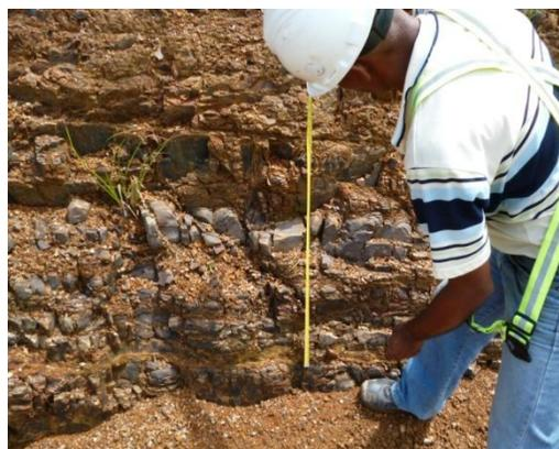
**Figura 36.** Medición de la separación en junta favorable S del talud 2, primera parte.
