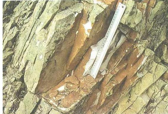
**Figura 26.** Alteración por oxidación en las superficies de discontinuidad de un macizo rocoso de cuarcitas mientras que la matriz rocosa permanece fresca. (Ferrer,2004)
