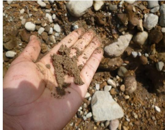
**Figura 76.** Talud 7 tercera parte, conformado por suelo residual de matriz limo arenosa más material aluvial.
