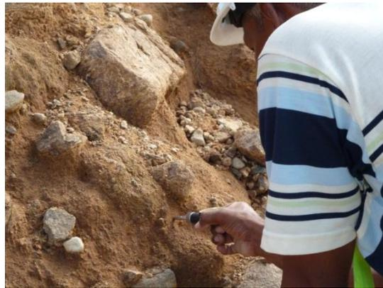
Figura 70. Medida de la resistencia en suelo del Talud 6 primera parte.
