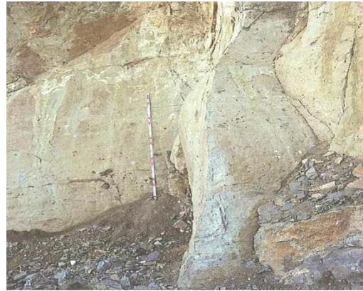
**Figura 19.** Discontinuidad ondulada lisa con alta continuidad en un macizo volcánico. (Ferrer,2004)
