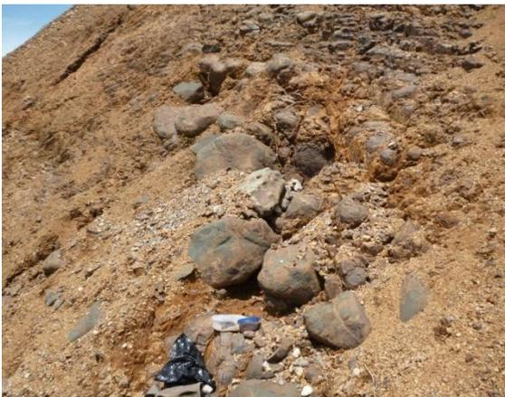
Figura 62. Talud 4 parte norte del cerro La Potra conformado por suelo residual de matriz arcilla limosa.
