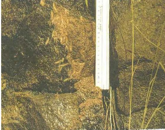
**Figura 27.** Circulación de agua a favor de discontinuidades en un macizo rocoso muy meteorizado de areniscas. (Ferrer,2004)
