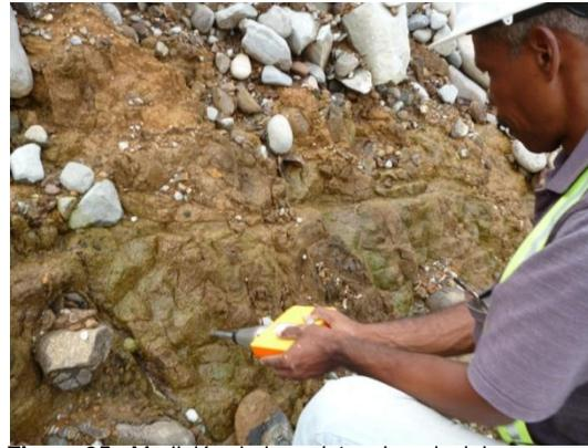
**Figura 95.** Medición de la resistencia uniaxial a compresión del talud 8, quinta parte.
