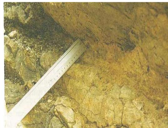
**Figura 24.** Discontinuidad ondulada rugosa, con abertura muy ancha y relleno arcilloso. (Ferrer,2004)
