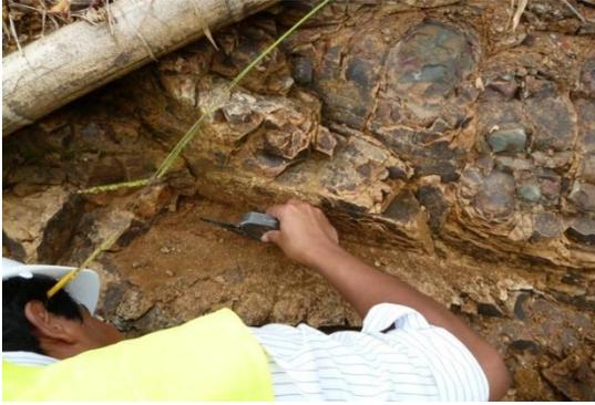
Figura 41. Medida del buzamiento de  $J_1$  del talud 2, segunda parte.
