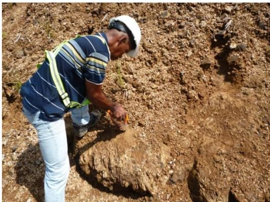
**Figura 55.** Medición de la resistencia uniaxial a compresión de J<sub>1</sub> del talud 3.
