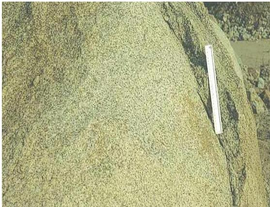
**Figura 8.** Roca ligeramente decolorada, con cambios en el color original de la matriz rocosa. (Ferrer,2004)
