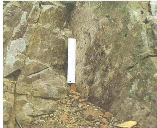
**Figura 20.** Discontinuidad plana rugosa en cuarcitas. (Ferrer,2004)
