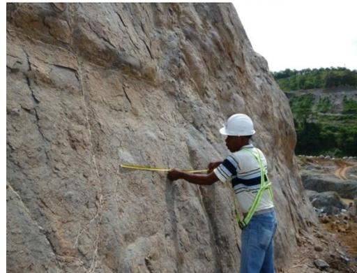
Figura 79. Medida de la separación de  $J_1$  talud 7, quinta parte, se aprecia además la junta favorable de estratificación en la parte superior de la imagen.
