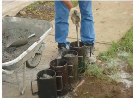
Figura 5. Preparación de las muestras de concreto para la prueba de resistencia a la compresión.
