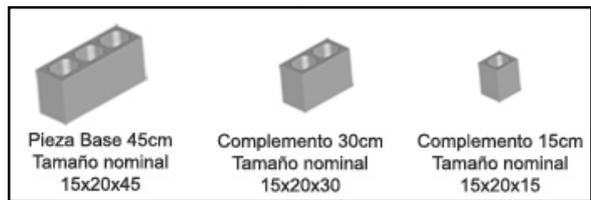
Figura 1. Tipos de bloques del sistema Modublock. Fuente: Manual para la construcción de edificaciones mediante el uso del sistema Modublock.
