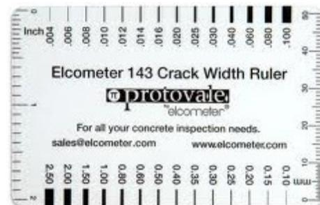
**Figura 9.** Regla para espesor de grietas.
