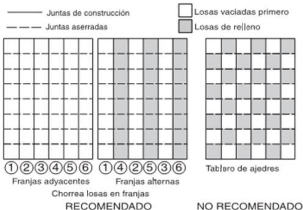
Figura 29. Recomendaciones para el colado de losas sobre el terreno.
