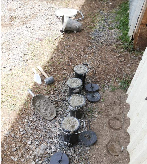
**Fotografía 15.** Muestreo de cilindros de concreto.
