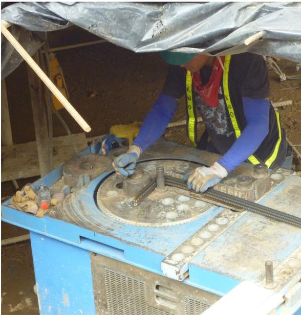
**Fotografía 12.** Máquina dobladora para acero de refuerzo.
