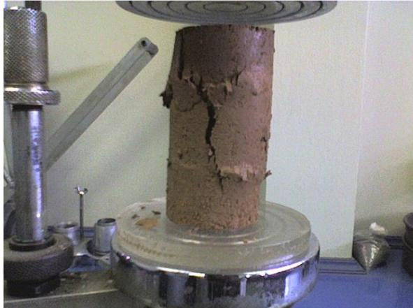
Figura 21. Espécimen fallado. Suelo 3,  $S_r=53\%$
