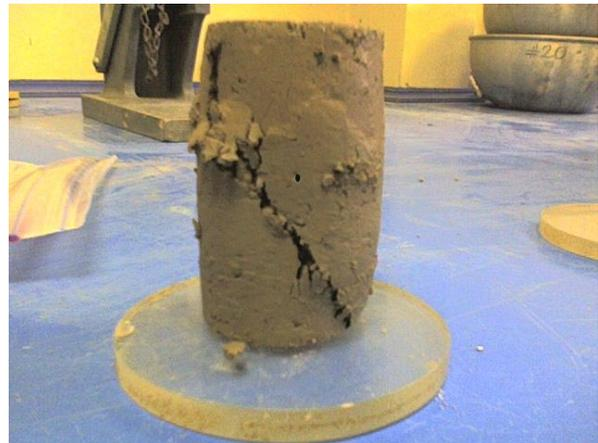
**Figura 19.** Espécimen fallado. Suelo 1,  $S_r=80\%$
