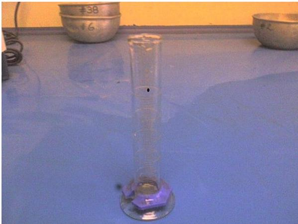
**Figura 12.** Probeta para 25ml con incertidumbre de 0,5ml.
