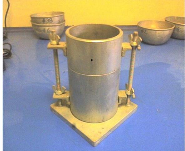
Figura 13. Molde para el ensayo Proctor Estándar, método A y B.
