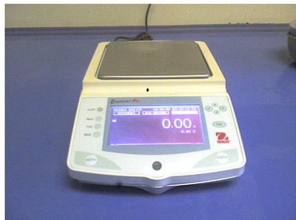
**Figura 10.** Balanza digital con una precisión de 0,01g.
