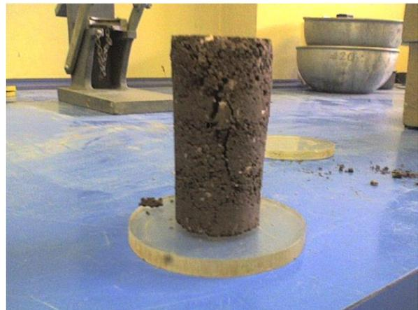
**Figura 20.** Espécimen fallado. Suelo 2,  $S_r=70\%$
