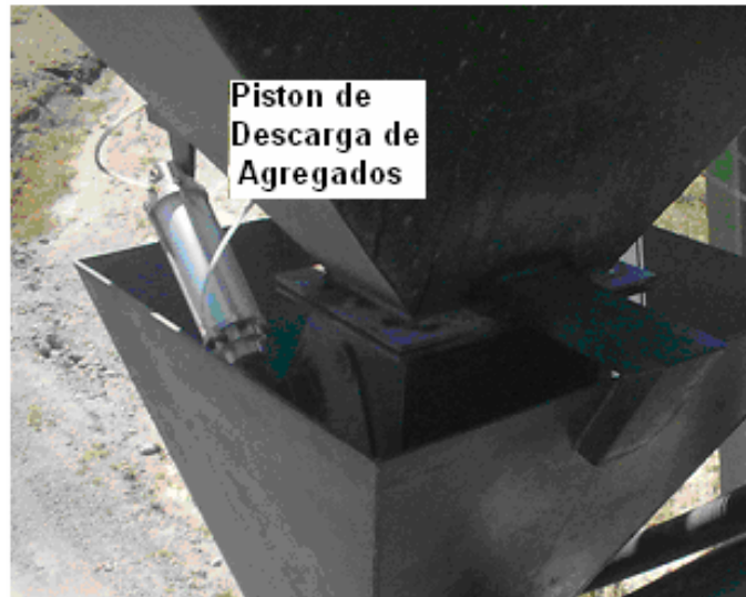
Figura 15: Pistón utilizado en la descarga de agregados.
