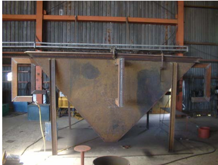
Figura 9: Estructura de Tolva de Agregados
