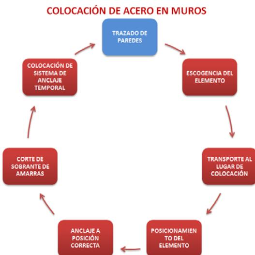
Figura 7. Diagrama del Proceso de Colocación de Refuerzo de Acero en Muros (Creado en Microsoft Word 2007)
