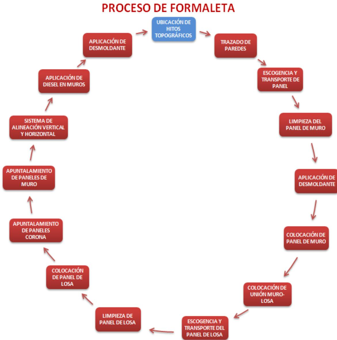
Figura 9. Diagrama del Proceso de Colocación de Formaleta
