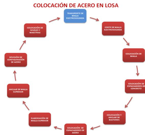
Figura 8 Diagrama del Proceso de Colocación de Refuerzo de Acero en Losa (Creado en Microsoft Word 2007)
