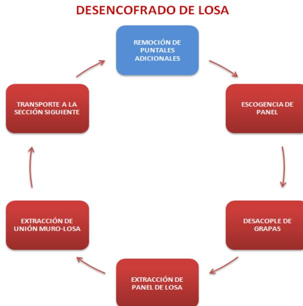
Figura 11- Diagrama del Proceso de Desencofrado de Losa
