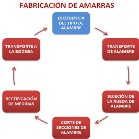
Figura 5. Diagrama del Proceso de Fabricación de Amarras (Creado en Microsoft Word 2007)
