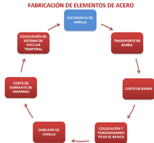
Figura 6. Diagrama de la Fabricación de Elementos de Acero (Creado en Microsoft Word 2007)
