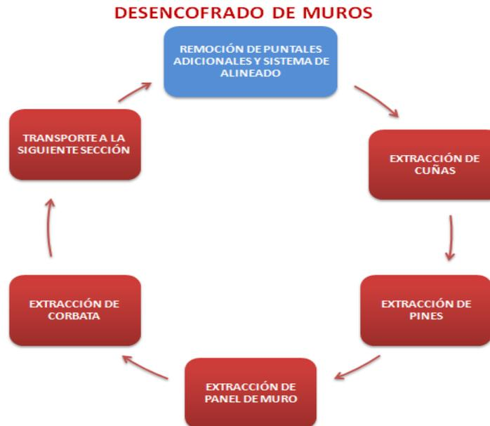
Figura 10 - Diagrama del Proceso de Desencofrado de Muros
