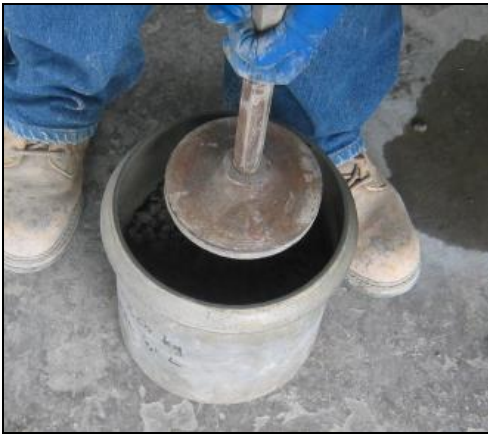
Fig 47. Determinación del peso unitario mezcla óptima
