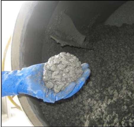
Fig 44. Trabajabilidad de la mezcla óptima
