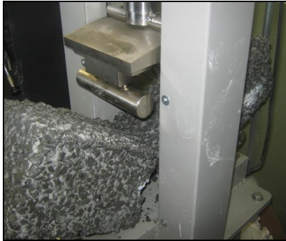
Fig. 51. Falla de vigas por flexión de la mezcla óptima a los siete días
