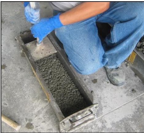
Fig 44. Trabajabilidad de la mezcla óptima
