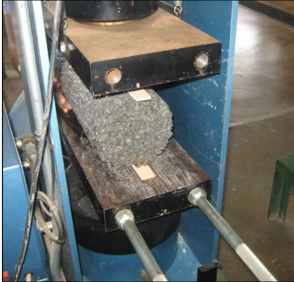
Fig 8. Ensayo de tracción indirecta o prueba brasileña Fuente: Fotografías tomadas durante la investigación
