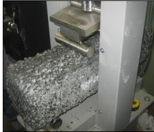
Fig 7. Ensayo para determinar la resistencia a la flexión Fuente: Fotografías tomadas durante la investigación
