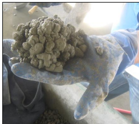
Fig 37. Trabajabilidad mezcla 2 (M2)
