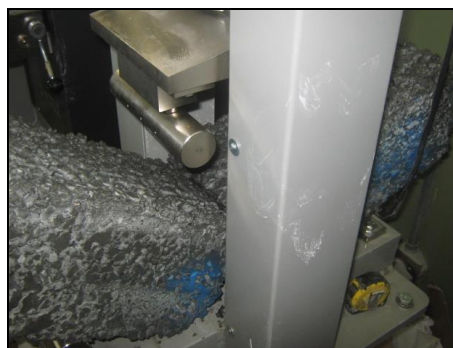
Fig 36. Falla de vigas por flexión a los catorce días de la mezcla 1 (M1)
