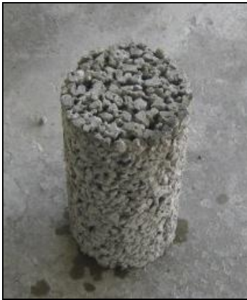
Fig 47. Determinación del peso unitario mezcla óptima
