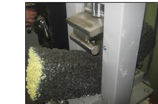
Fig 43. Falla de vigas a flexión a los catorce días de la mezcla concretera (MC)
