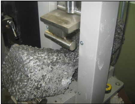
Fig 40. Falla de vigas por flexión a los catorce días de la mezcla 2 (M2)
