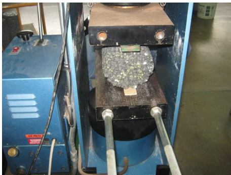
Fig 56. Falla de cilindros a los veintiocho (falla a tensión indirecta) de la mezcla óptima
