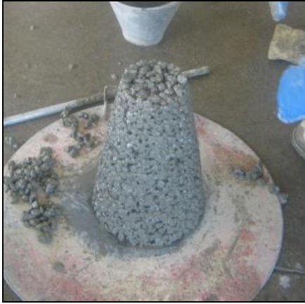
Fig 38. Revenimiento mezcla 2 (M2)
