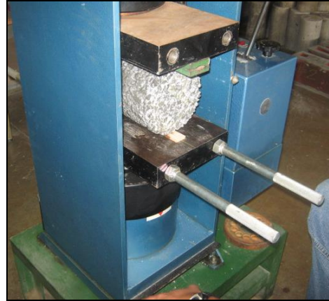
Fig 53. Falla de cilindros a los siete días (falla a tensión indirecta) de la mezcla óptima
