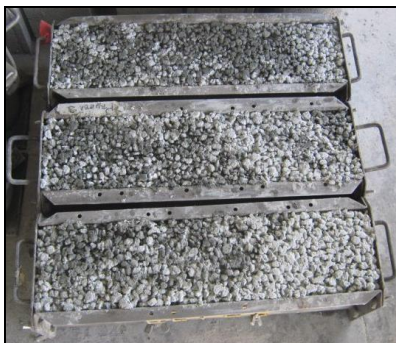
Figura 12. Moldeo de vigas
