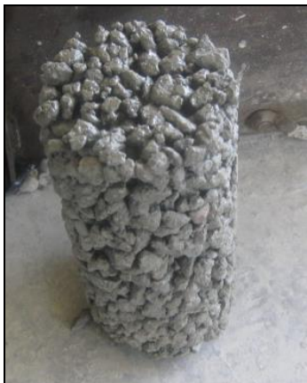
Fig 32. Cilindros utilizados para medir la permeabilidad del concreto
