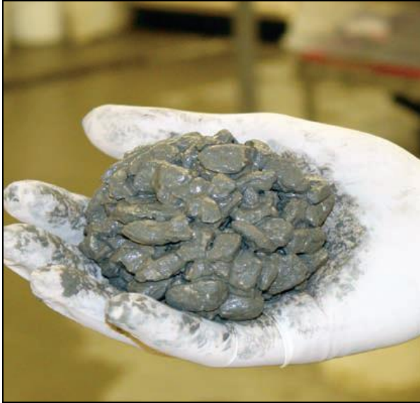
Fig. 5. Trabajabilidad del concreto poroso utilizando aditivos Fuente: Pervious Concrete Brochure. Euclid Chemicals
