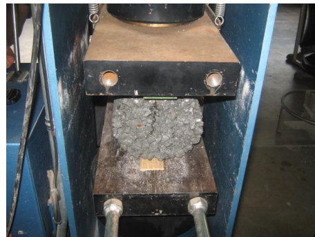
Fig 55. Falla de cilindros a los catorce días (falla a tensión indirecta) de la mezcla óptima
