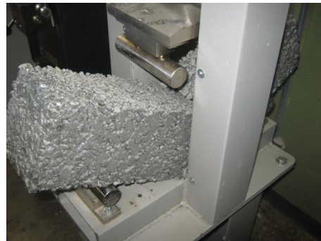
Fig 54. Falla de vigas a los catorce días (falla a flexión) de la mezcla óptima
