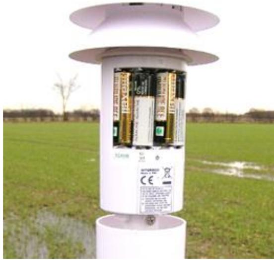
Figura 4.1. Estación Oregon, compartimento para las baterías
