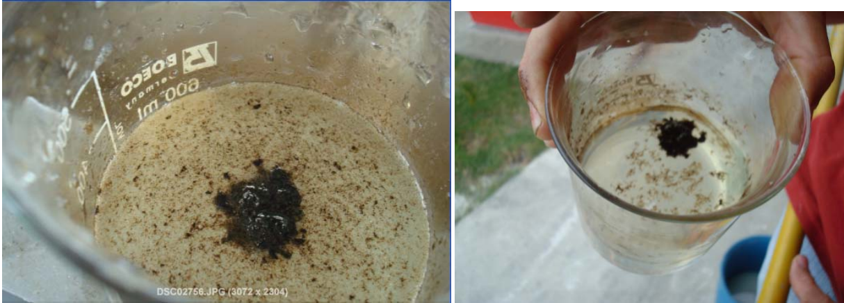
Figura 39. Prueba con 80 ppm de Coagulante PIX y 8 ppm de Flocculante 4893
