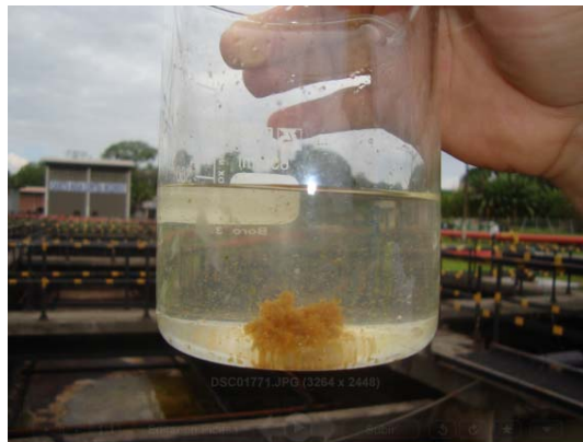
Figura 22. Coagulante Kemira PIX-111Cloruro férrico1% 120 mg/l y Floculante CALLAWAY C-4330 0,1% 20 mg/l
