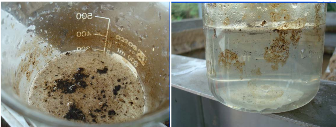
Figura 38. Prueba solo adicionando 16 ppm de floculante
