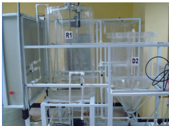
Figura 34. Modulo de Tratamiento de sedimentación con Coagulación- Floculación Previas
