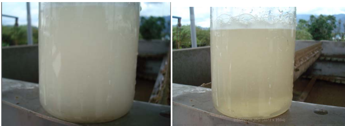
Figura 35. Agua saturada a 120 Psi
