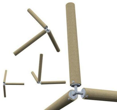
**Figura 34. ESTRUCTURA MODULAR CON TUBOS DE CARTÓN.**
