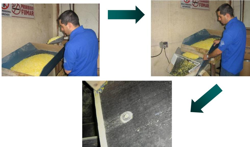
**Figura 33. SEPARACIÓN DEL METAL-PLÁSTICO POR IMANES.**
