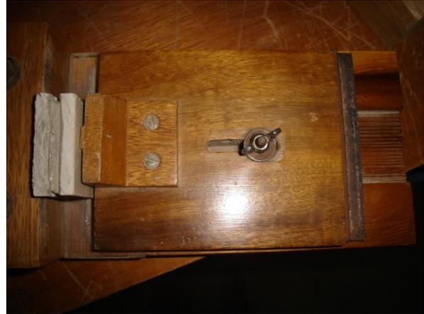
**Figura 1.** Máquina de cortante para cerámicas.
