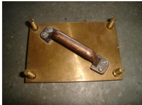
**Figura 2.** Herramienta Mat'l Brass para determinar el tiempo abierto en las mezclas de mortero.
