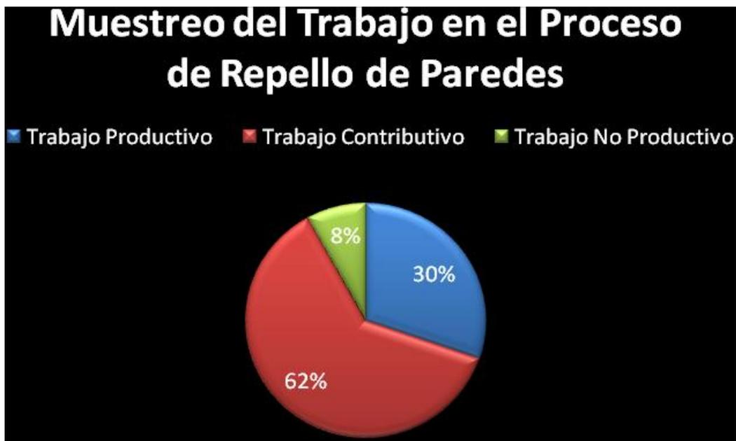
Figura N°31. Gráfico del muestreo de trabajo para el proceso de repello de paredes. Apéndice N°20
