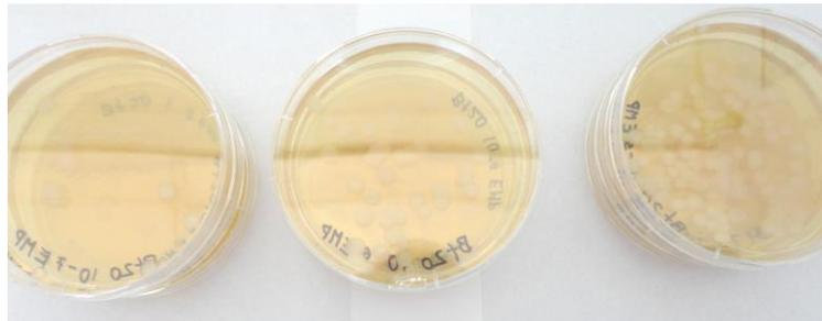
**Figura 9.** Placas Luria-Bertani gelificado con agar al 1,5% (m/v) con las diluciones de  $10^{-5}$ ,  $10^{-6}$  y  $10^{-7}$ , donde se observa que la proporción de esporas que se ubica entre 30 y 300 UFC/mL fue la dosis de  $10^{-5}$ , la cual se utilizó como base para continuar haciendo la cuantificación de esporas a dicha dilución.
