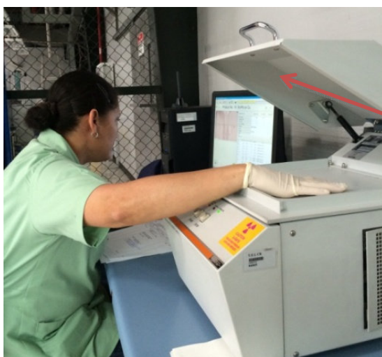
Figura 33. Fuentes de Rayos X FISCHERSCOPE® X-RAY ZAN 215.
