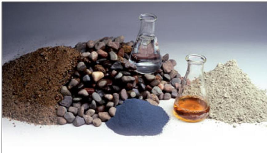
**Figura 2.14** Componentes del concreto hidráulico: arena, grava, agua, cemento, aditivos y adiciones.
