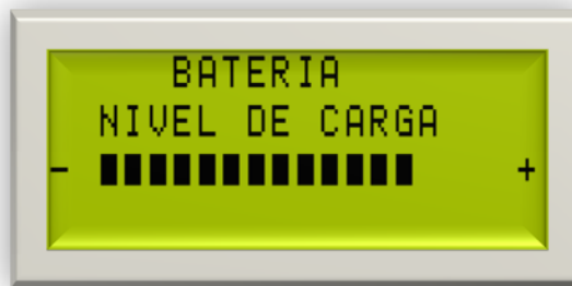
Figura 5.24 Representación visual en el LCD del estado de carga de la batería.
