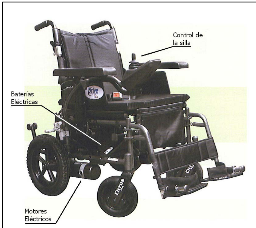
Figura 3.1 Estructura básica de una silla de ruedas eléctrica.
