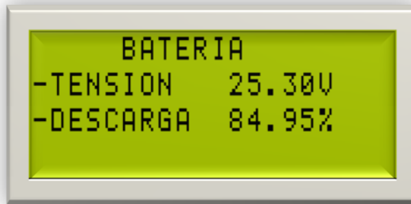
Figura 5.27 Representación visual en el LCD de la tensión y porcentaje de descarga de la batería.
