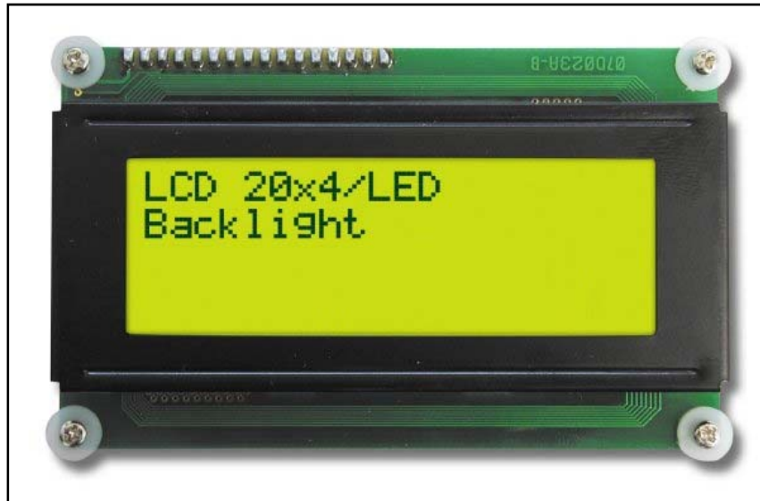
Figura 5.14 Pantalla LCD de 20 columnas y 4 líneas con luz de fondo.
