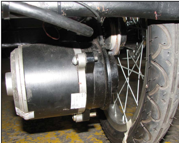
Figura 5.34 Motor de imanes permanentes con adaptación para llantas de bicicleta.
