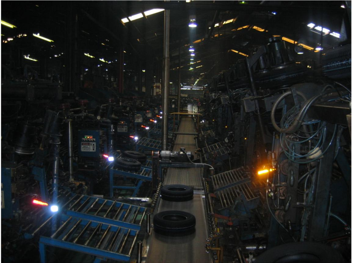
**Figura 1.1** Banda transportadora de llantas
