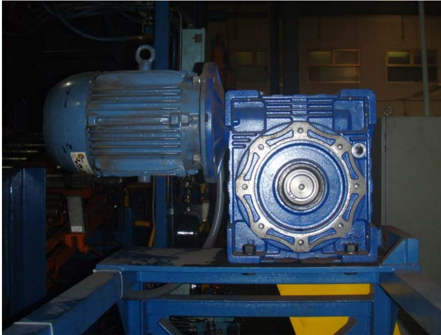
**Figura 3.2** Motor de la banda transportadora M1 con reductor de velocidad tipo NMRV 130.
