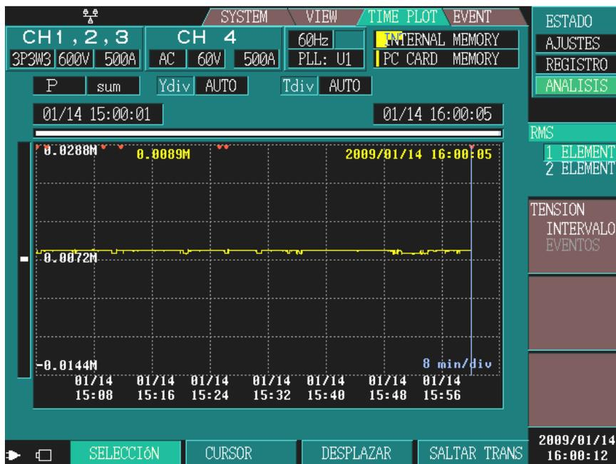
**Figura 6.2** Gráfica de potencia trifásica(MW) versus tiempo(s), con el sistema de dosificación antiguo, para una hora de medición con el HIOKI 3196.
