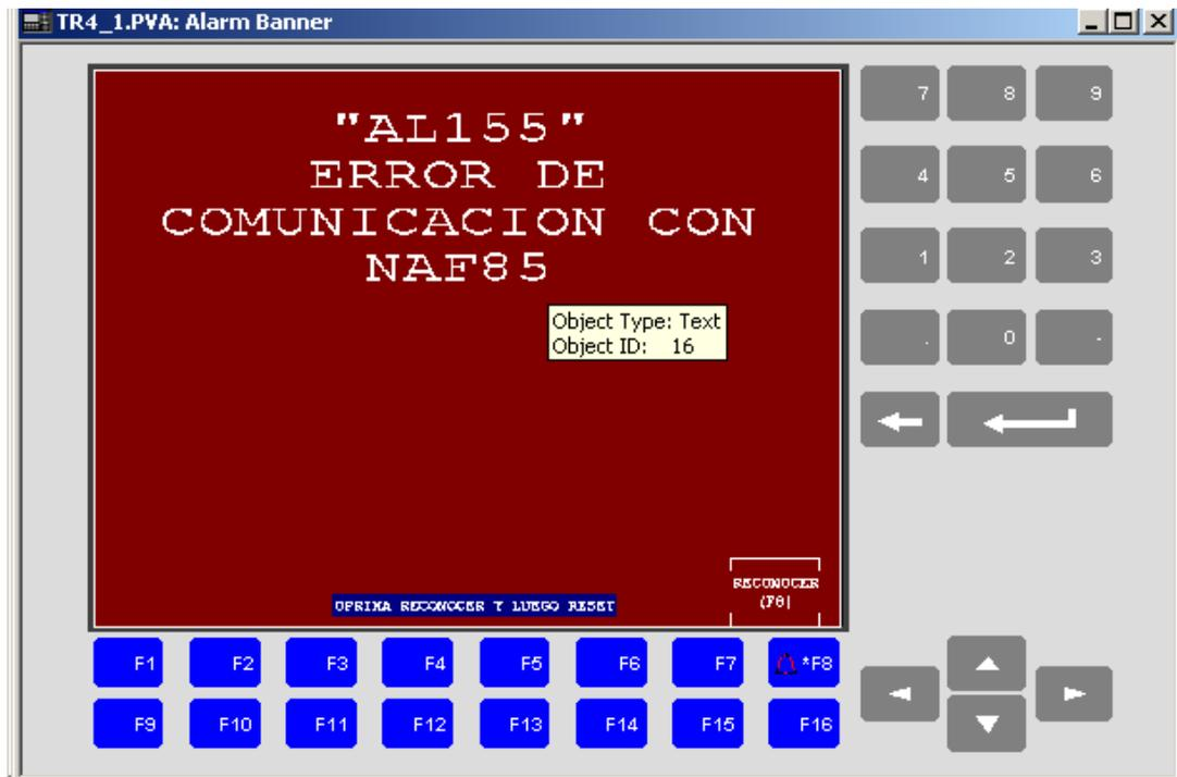
**Figura 6.9** Pantalla de emisión de alarmas del sistema.
