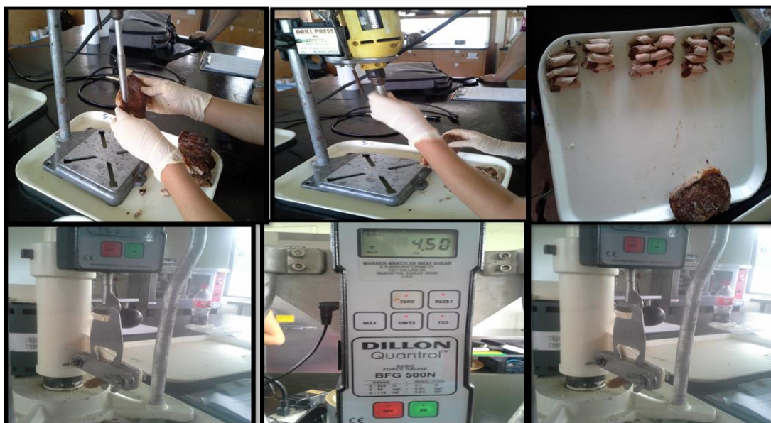
Figura 15. Preparación de los cilindros para medición de fuerza de corte en sub muestras de Longissimus dorsi lumborum .
