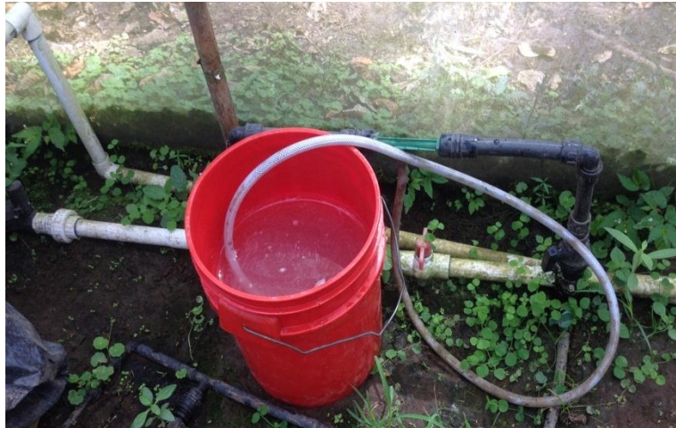
Figura 5. Sistema de inyección de fertilizantes tipo Venturi utilizado en el ensayo de variedades de lechuga ( Lactuca sativa L. ), en San Miguel de la Tigra, San Carlos, C.R.
