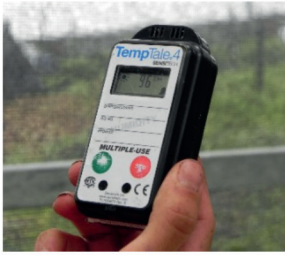
Figura 4. Equipo de monitoreo: A) Datalogger para registro de datos de temperatura y humedad ambiental, B) Conductímetro para monitoreo de conductividad eléctrica-concentración, C) medidor de pH portátil para monitoreo de la acidez de la solución nutritiva
