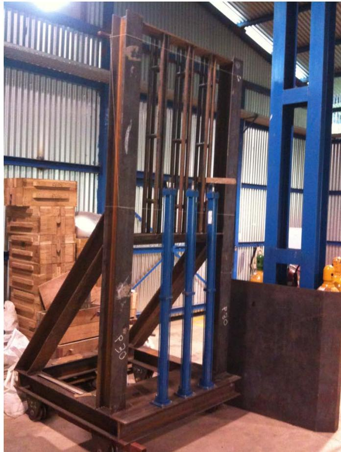
**Figura 5.19** Pistones hidráulicos posicionados en el tren principal.
