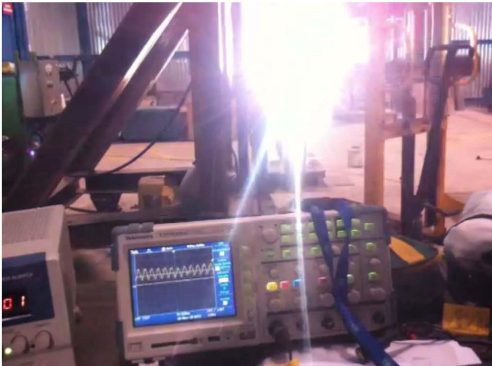
**Figura 6.12** Tensión de salida del transductor con electrodo de grafito controlado por control automático.
