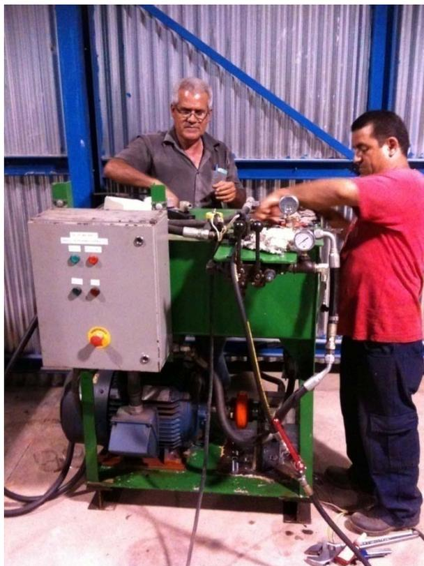
**Figura 6.3** Banco de pruebas hidráulico.
