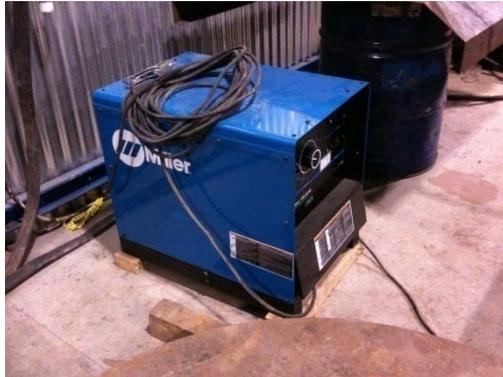
**Figura 6.4** Máquina de soldar Dialarc 250 AC/DC.
