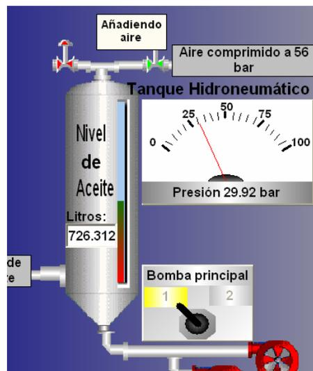
**Figura 50.** Sistema compensando el bajo valor de la presión en el acumulador.
