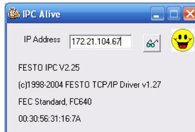
**Figura A.4** Detección del IPC FEC640 en la red usando IPC Alive.
