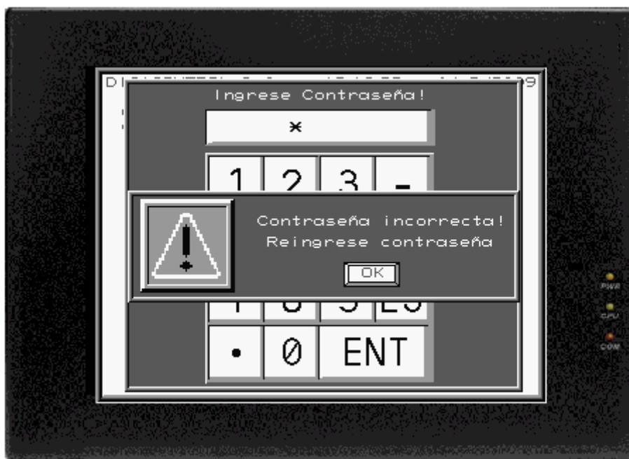
**Figura 5.36** Pantalla del HMI para control de contraseñas, contraseña incorrecta
