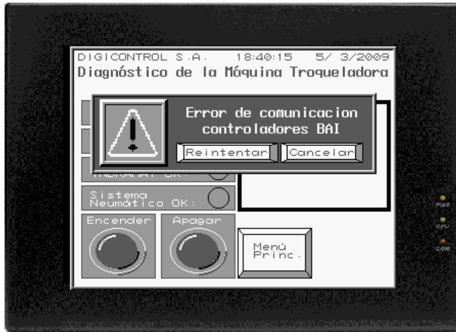
**Figura 6.8** Pantalla tomada en la prueba de error en controladores BAI, simulación online.
