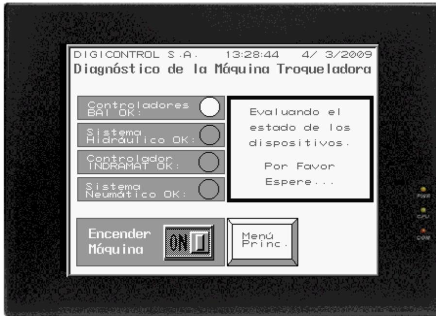
**Figura 5.35** Pantalla del HMI para diagnóstico de la máquina.
