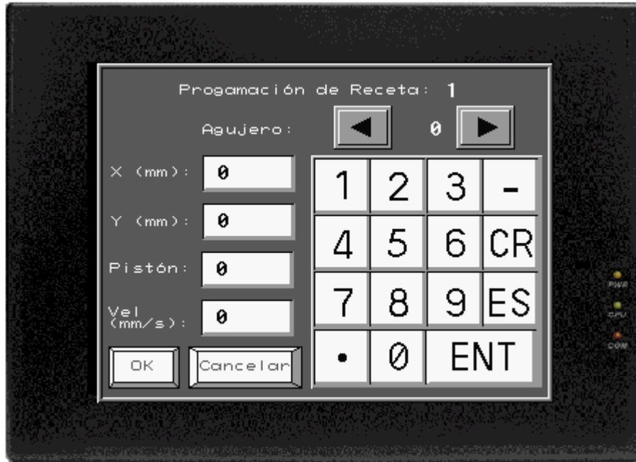
**Figura 5.38** Pantalla del HMI, programación de recetas.
