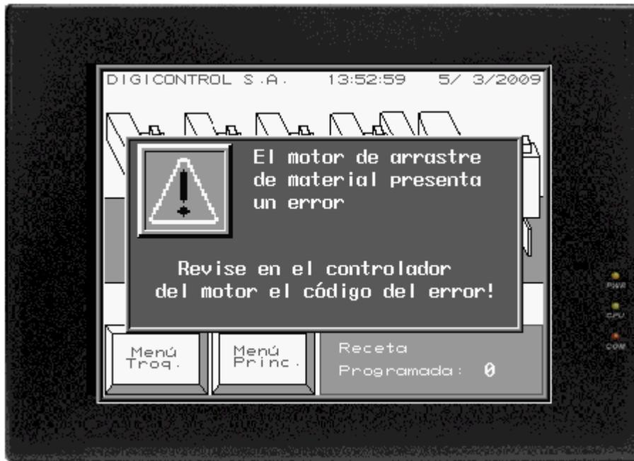
**Figura 6.7** Pantalla tomada en la prueba de error de servocontrolador Indramat, simulación online.
