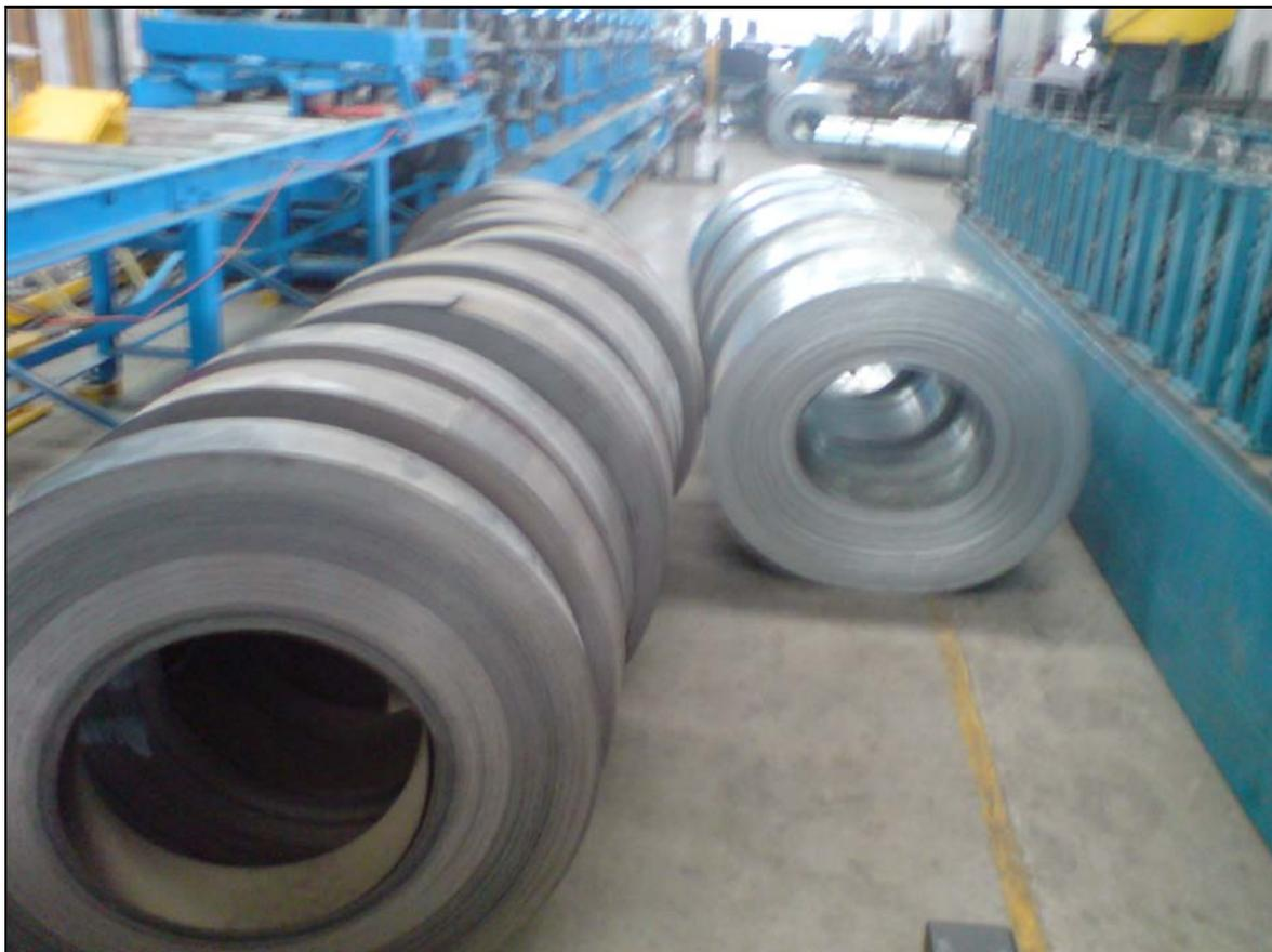
**Figura 3.2** Carruchas (bobinas) para la fabricación de rieles.
