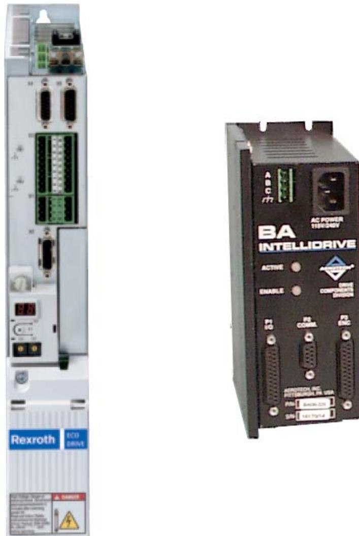
**Figura 5.14** Controladores de servomotor utilizados.
