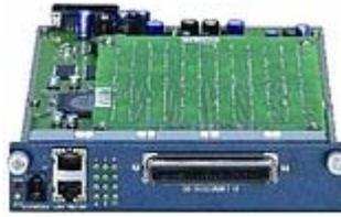
**Figura 18.15** Módulo del DSLAM IP
