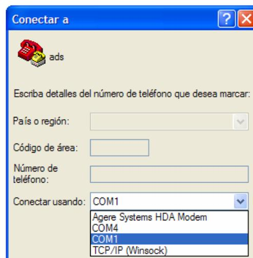
**Figura 18.22** Interfaz de selección de puerto de comunicación del hyperterminal
