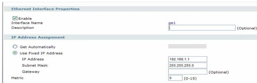
**Figura 18.8** Interfaz de configuración del puerto LAN
