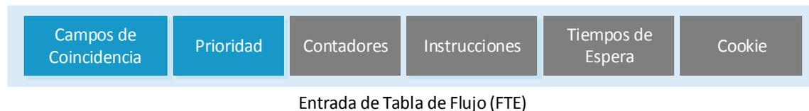
Figura 2.3 Componentes principales de una entrada de flujo. Fuente: (Open Networking Foundation, 2013, p. 15)
