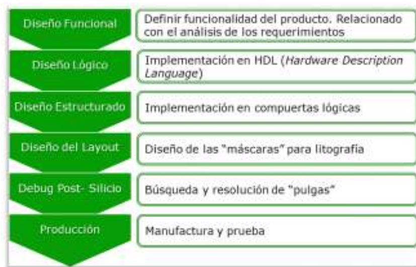
Figura 4: Proceso de diseño de circuitos integrados VLSI
