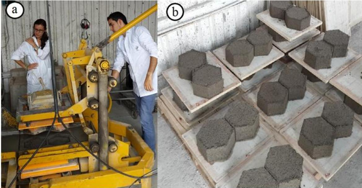
**Figura 2.** Máquina para la fabricación de los adoquines (a) y forma de los adoquines (b).
