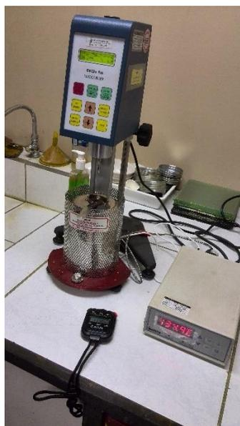
Figura 7. Ensayo de viscosidad rotacional.
