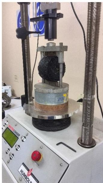
Figura 18. Ensayo de tensión diametral retenida de mezcla asfáltica.
