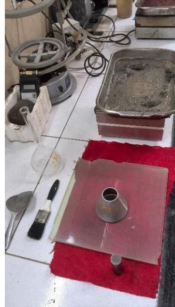
Figura 4. Ensayo de gravedad específica a los agregados finos
