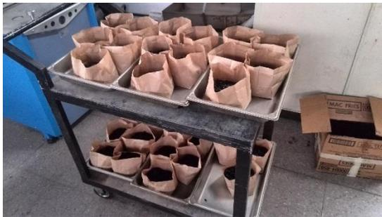
Figura 14. Pesos para elaboración de pastillas Marshall.
