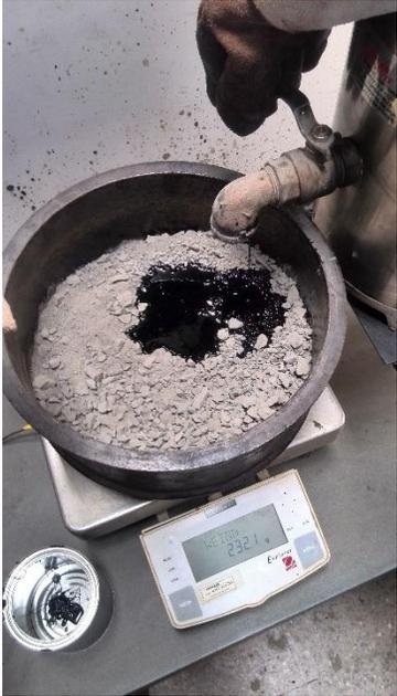
Figura 11. Pesaje del asfalto para la elaboración de mezcla asfáltica.
