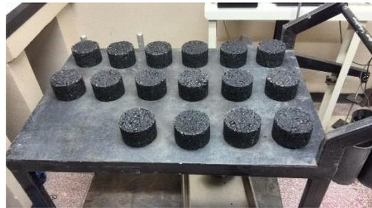
Figura 16. Pastillas Marshall desmoldadas.
