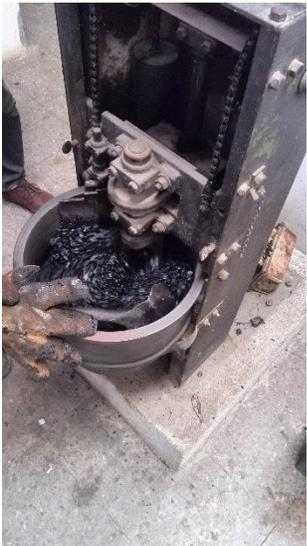
Figura 12. Mezclado de agregado y asfalto.
