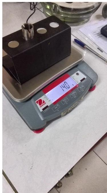
Figura 8. Pesaje para ensayo de densidad del ligante asfáltico.
