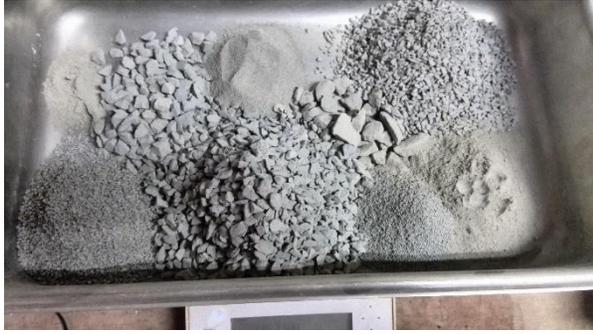
Figura 9. Preparación de pesos para elaboración de mezcla asfáltica
