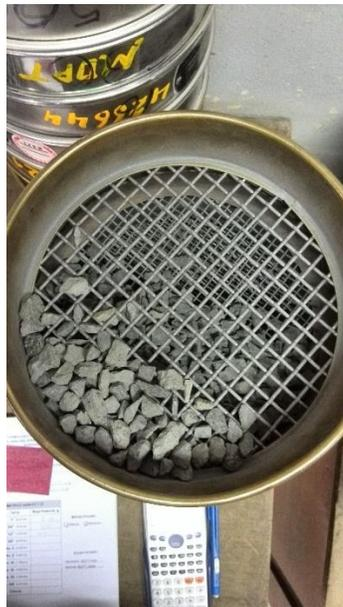
Figura 3. Ensayo de granulometría.
