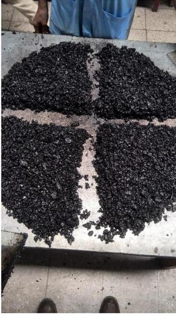
Figura 13. Cuarteo de la mezcla asfáltica elaborada en laboratorio, para posterior pesaje para elaboración de pastillas Marshall.
