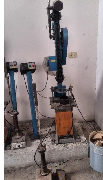
Figura 15. Compactador mecánico Marshall.
