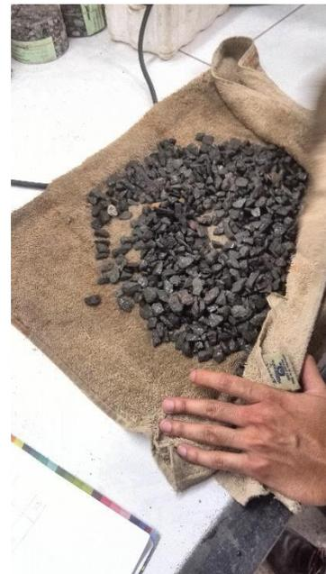
Figura 5. Gravedad específica a los agregados gruesos
