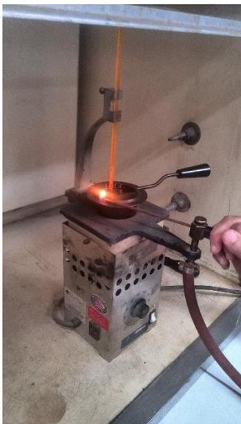
Figura 6. Ensayo de punto de inflamación.
