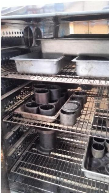
Figura 10. Preparación de pesos y moldes para la elaboración de mezcla asfáltica y pastillas Marshall
