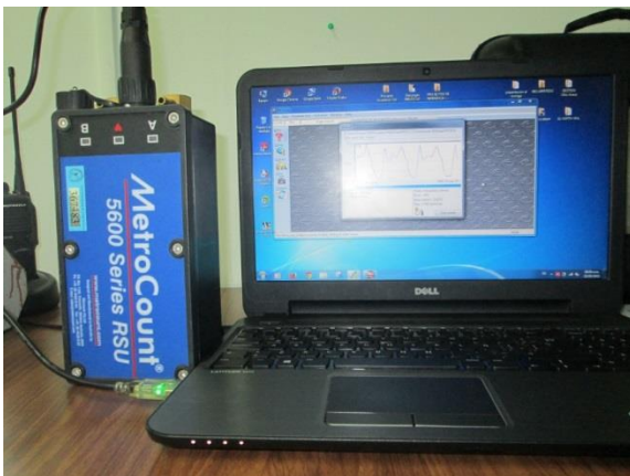
Imagen 10. Transferencia de información del contador al ordenador. Fuente: Propia.
