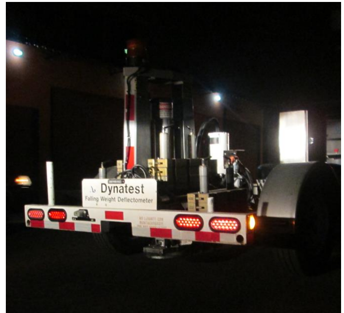
Imagen 11. Equipo utilizado para realizar las pruebas de deflectometría de impacto. Fuente: Propia.
