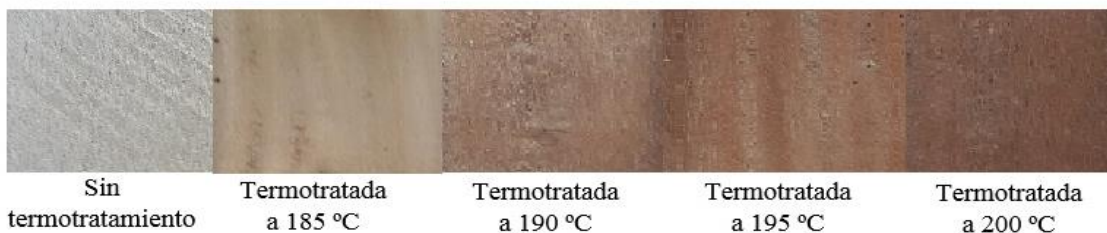
Figura 8. Cambios de color en la madera de a) Tectona grandis y b) Gmelina arborea , de acuerdo a las diferentes temperaturas de termotratamiento definidas.
