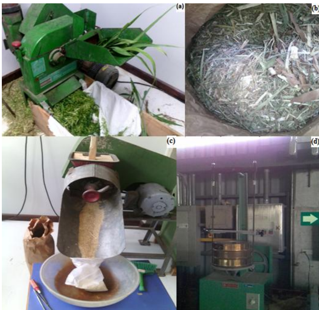
Figura 5. Procesado del material cosechado para pruebas energéticas y químicas. Astillado del pasto (a), material secado en horno solar (b), material molido (c) y material tamizado a 40-60 mesh (d).
