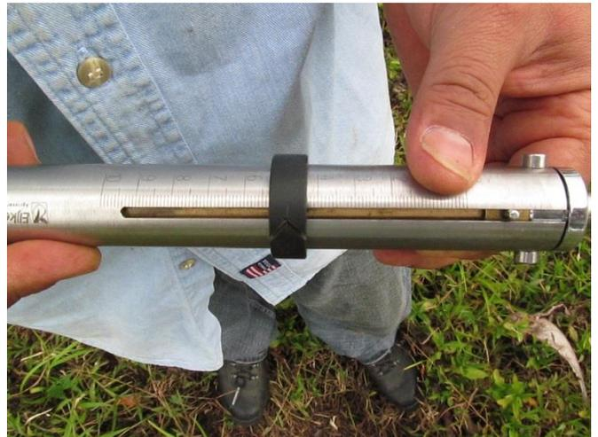
Figura 4. Uso del penetrómetro para el cálculo de la resistencia a la penetración
