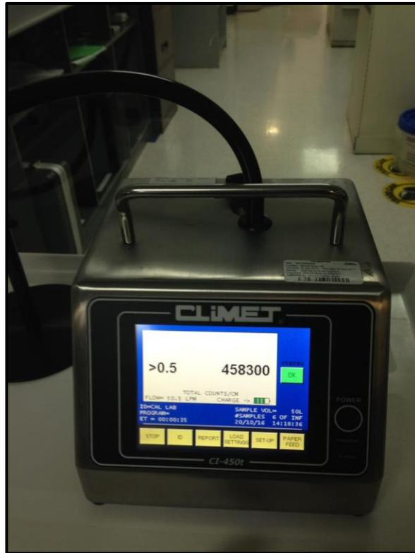
Figura 24. Contador de partículas, Manufacturador Climet.
