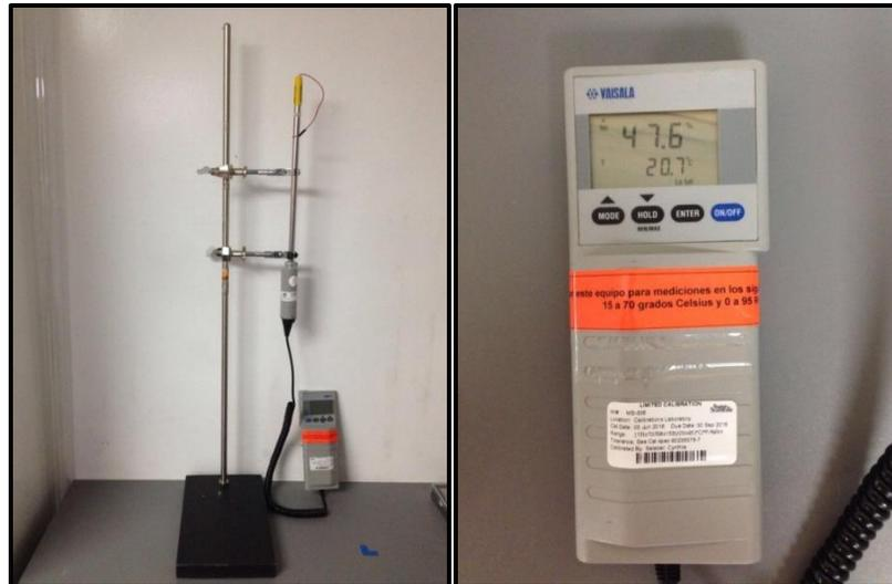
**Figura 30. Termo-higrómetro.**
