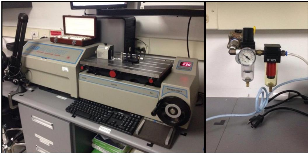
Figura 12. LabMaster y su toma de presión de aire.
