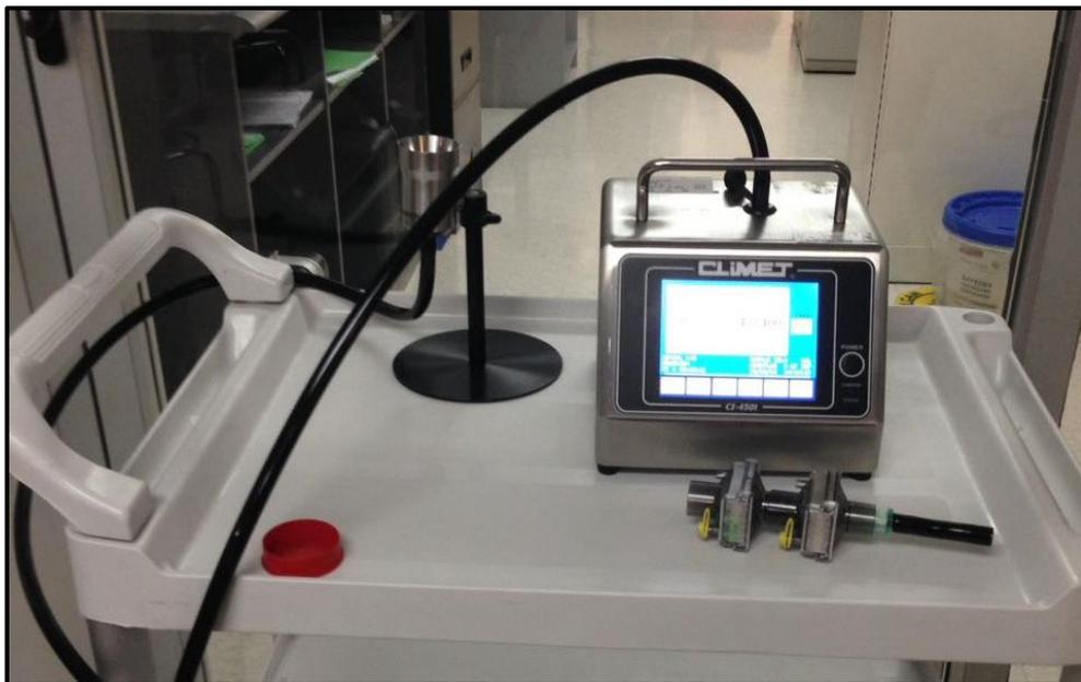
Figura 25. Contador de partículas, Manufacturador Climet.
