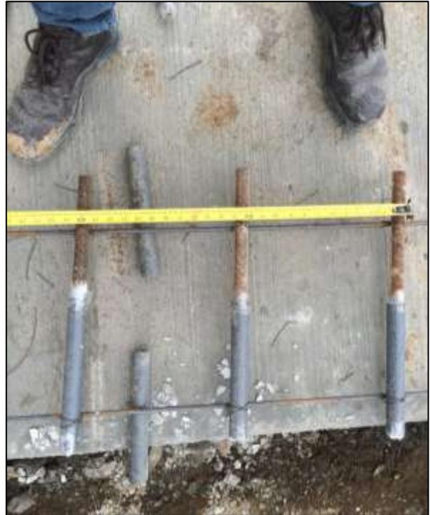
**Figura 19.** Inspección de dovelas para las losas de parqueos.
