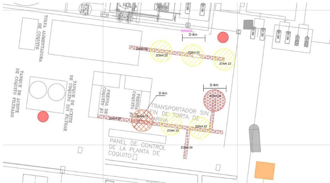
Ilustración 5 Clasificación de las zonas de peligrosidad debido a atmósferas explosivas en la Planta de Coquito
