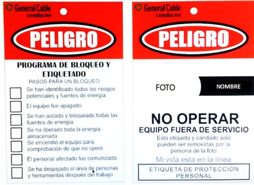
Figura M: Etiqueta para procedimiento de bloqueo y etiquetado de energías
