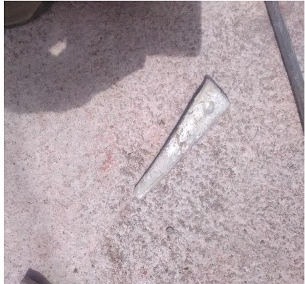
**Figura 12.** Clavijas sistema Faresin.
