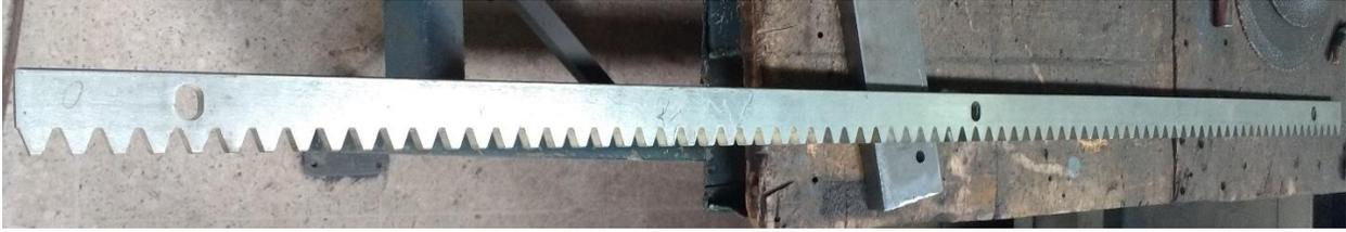
**Figura 6.34** Cremallera metálica con agujeros para su ensamble [23].
