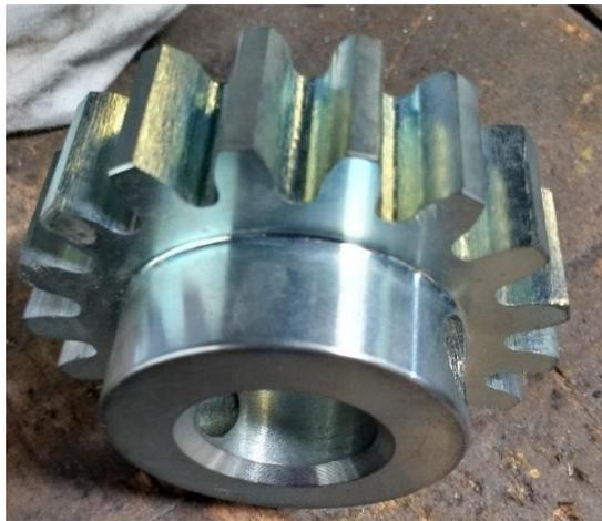
**Figura 6.32** *Piñón o engrane metálico [23].*
