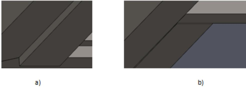
**Figura 6.24** Desnivel  $d$  en el tubo de 50.8x50.8mm a) extremo con 1cm de saliente y b) extremo sin saliente.
