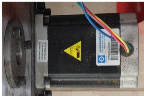
**Figura 6.28** Stepper motor de cuatro cables encontrado en la máquina CNC de producción industrial.
