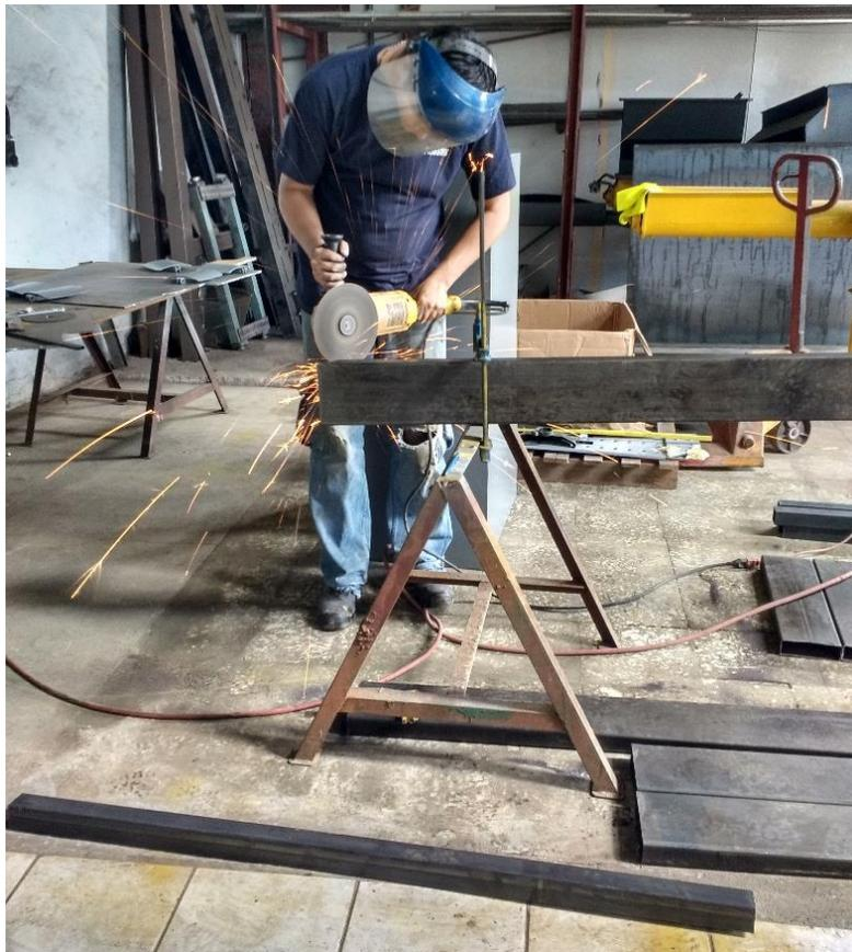
*Figura 6.1* Proceso de corte con disco.
