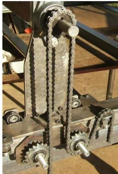
**Figura 6.32** Sistema de cadenas con engrane [22].
