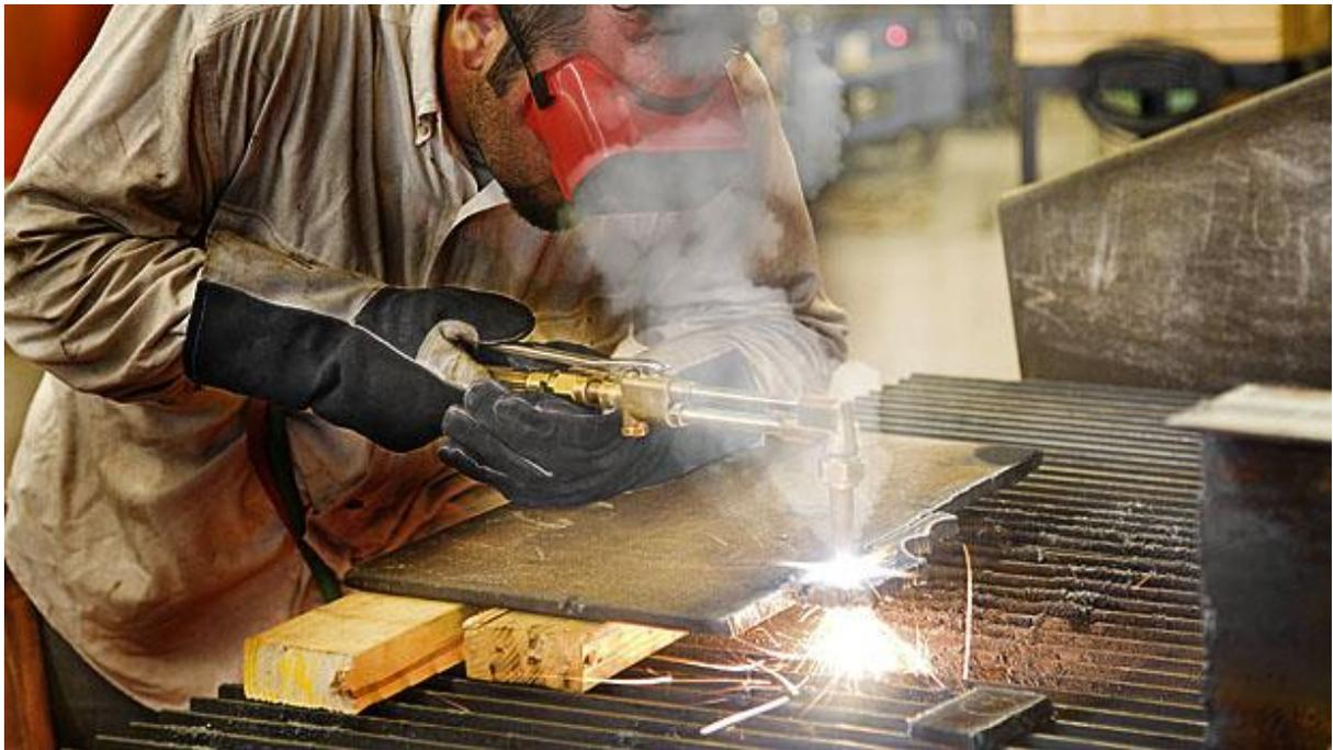
*Figura 3.5 Imagen ilustrativa de los humos y gases tóxicos generados en el corte por plasma [34].*
