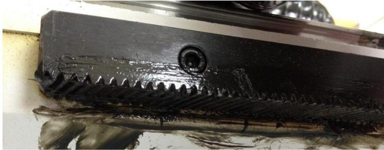
**Figura 6.31** Cremallera empleada en la máquina CNC de producción.
