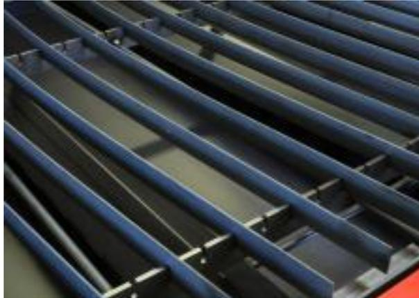
**Figura 6.14** Láminas de la cama metálica ubicadas en la cortadora de plasma [17].
