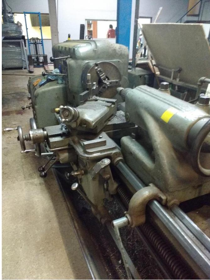
**Figura 6.4** *Proceso de torneado básico (no automático y sin rosca externa).*
