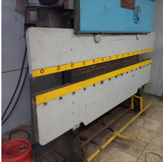
*Figura 6.2 Dobladora de láminas metálicas.*
