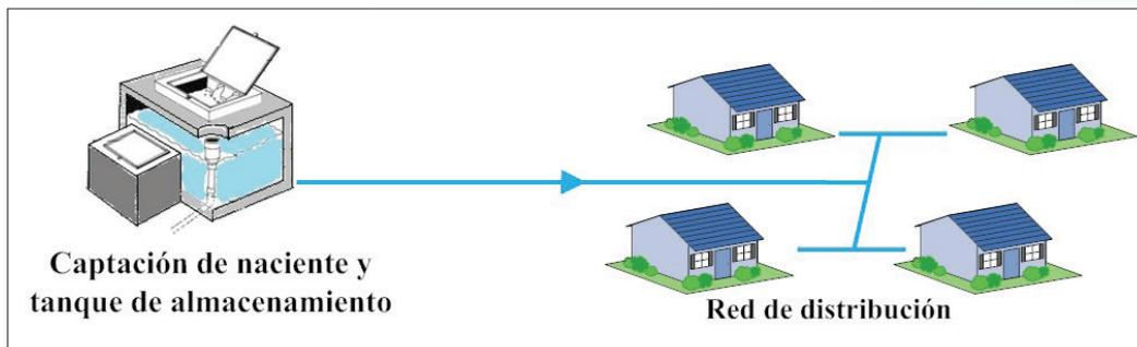
Figura 3.1. Esquema del sistema del acueducto de Jicotea.
